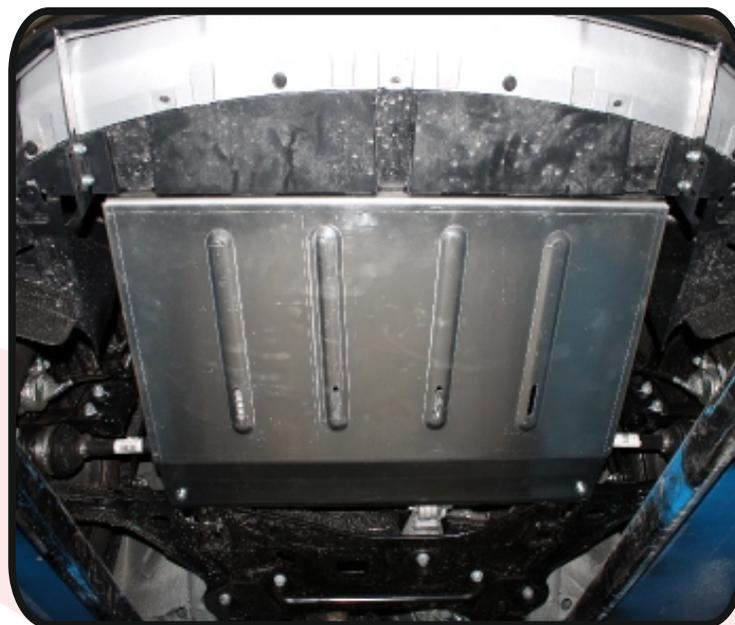
**Защита картера и КПП (алюминий) 4 мм
