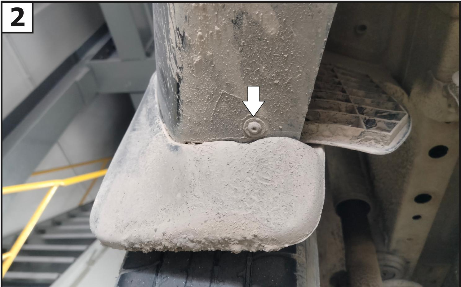
**Выкрутить винты крепления подкрылка и бампера снизу с левой и правой стороны автомобиля.**
