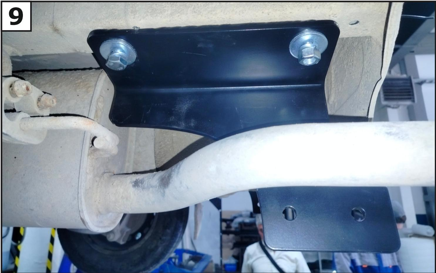
К установленным закладным закрепить левый (2) и правый (3) кронштейны с помощью болтов M12x1,25x40 (9), гаек M12x1,25 (12), шайб 12 пружинных (14) и шайб 12 увел. (15). Резьбовые соединения не затягивать.
