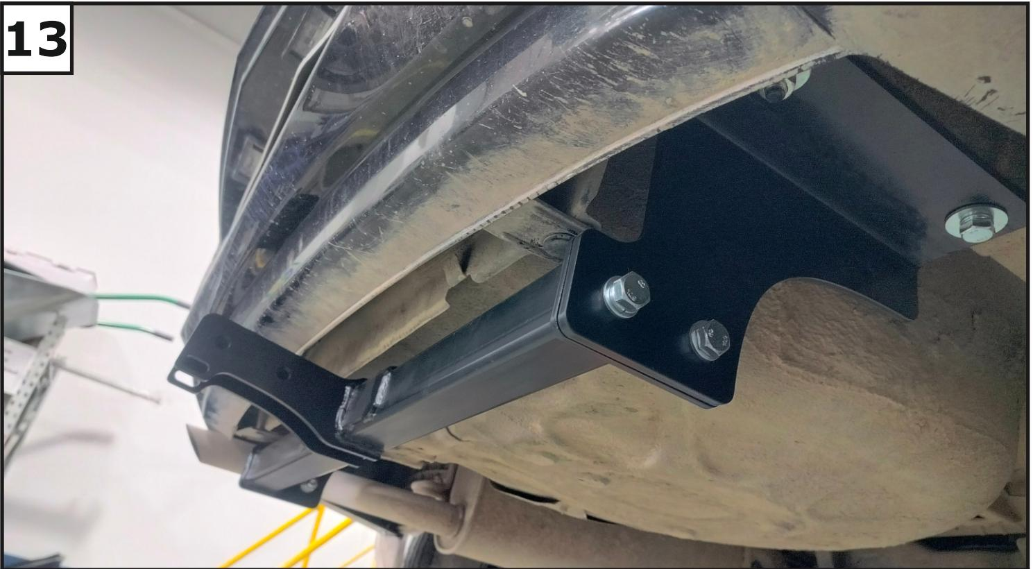
К установленным кронштейнам закрепить балку (1) с помощью болтов M12x1,25x40 (9), шайб 12 (16), шайб 12 пружинных (14) и гаек M12x1,25 (12). Затянуть резьбовые соединения балки с кронштейнам. Затем отрегулировать положение балки относительно центра автомобиля и затянуть резьбовые соединения кронштейнов к лонжеронам. Моменты затяжки: M12=81 Нм.
