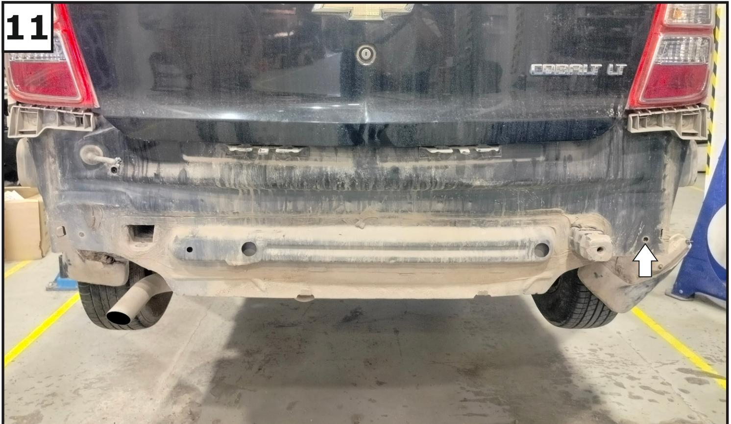
В отверстие в задней панели установить болтовое соединение в составе болта М6х50 (8), шайб 6 увел. (13) и гайки М6 (11). Затем установить буфер заднего бампера на место: в левый лонжерон - выступающей частью буфера, справа - на данное резьбовое соединение. После установить бампер в обратной последовательности.
