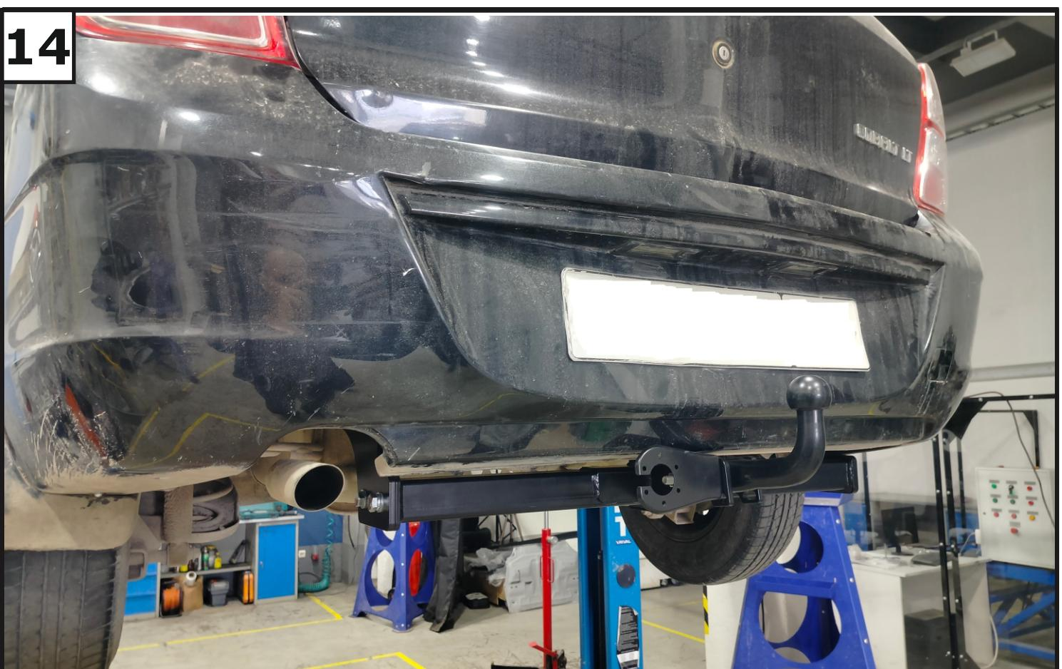
Установить кронштейн под розетку (6), крюк (7) и проставки (4) с помощью болтов M12x1.25x90 (10), шайб 12 пружинных (14), шайб 12 (16) и гаек M12x1.25 (12).
