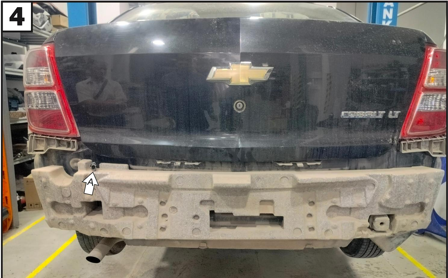
Демонтировать задний бампер, сняв его с защелок и отсоединив электрический разъем А.
