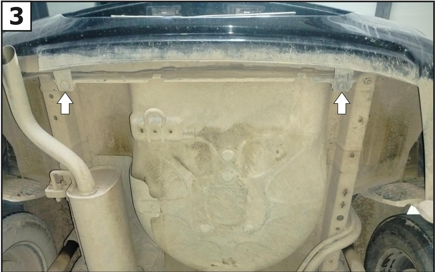
Демонтировать клипсы крепления бампера снизу автомобиля.
