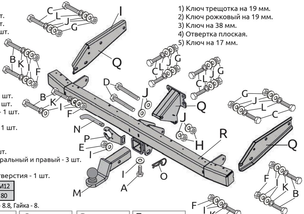
Table with 2 columns: Диаметр резьбы (M10, M12) and Момент затяжки, Нм (47, 80)
