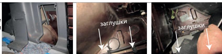
**ШАГ 2.** С помощью плоской отвертки найдите скрытые в лонжероне технологические отверстия. Проденьте болты M10x90 с надетыми на них шайбами и втулками в отверстия, через багажник автомобиля. Закрепите кронштейн.
