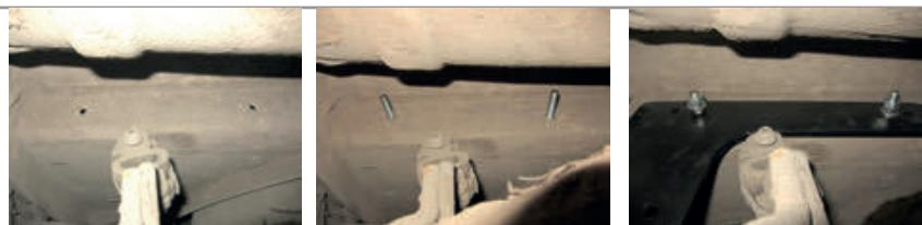
**ШАГ 4.** Перед установкой балки ТСУ ознакомьтесь со схемой крепежных отверстий в боковых кронштейнах.
