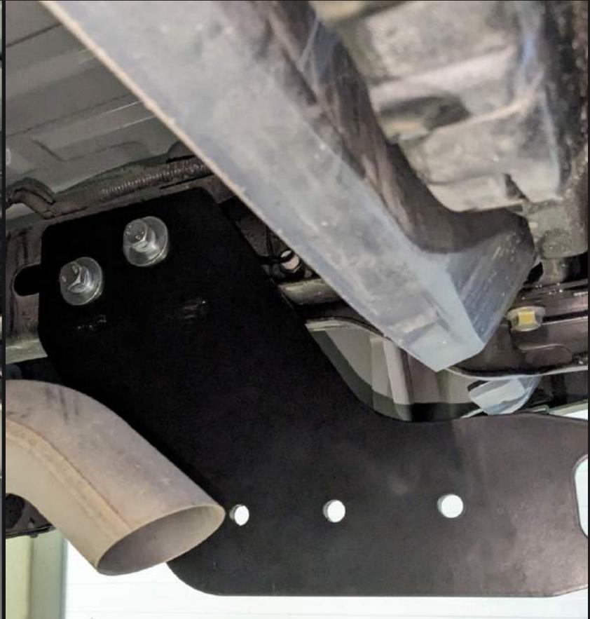
Установить в лонжерон закладные (6) и закрепить к ним кронштейн с помощью болтов M12x1,25x40 (14), шайб M12 пружинных (20) и шайб 12 увеличенных (22). Кронштейн левый (2) установить аналогично.
