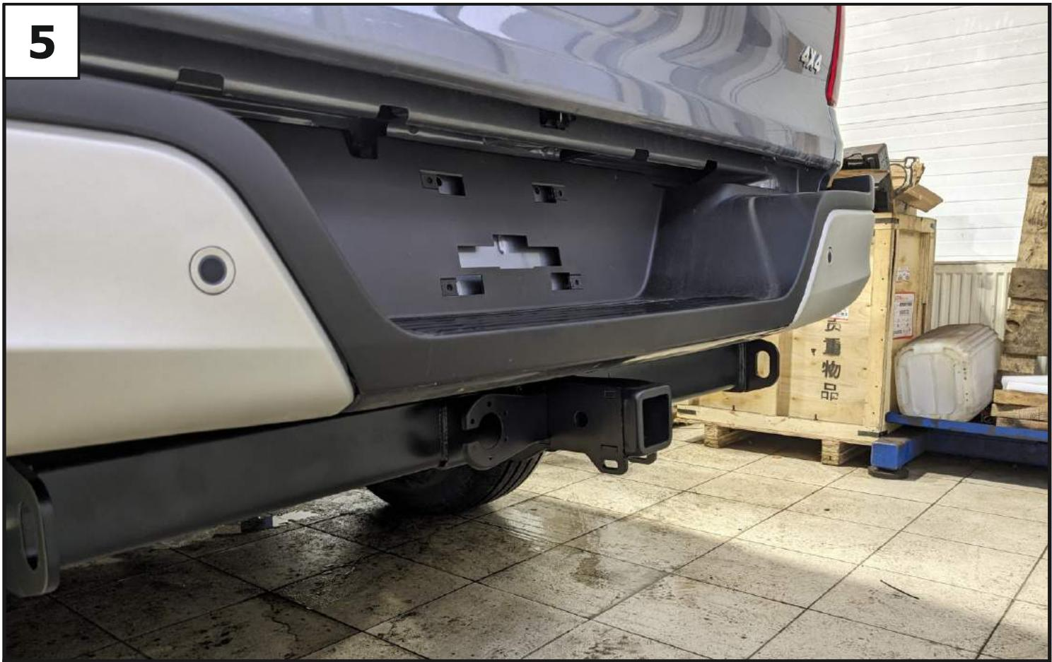
**Затянуть все резьбовые соединения: сначала балку с кронштейнами, затем кронштейны к раме. Моменты затяжки: M12=81 Нм.**
