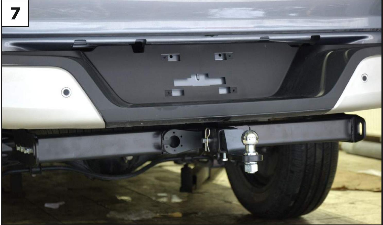
Установить переходник (7), закрепив с помощью штифта (9) и шплинта (10).
