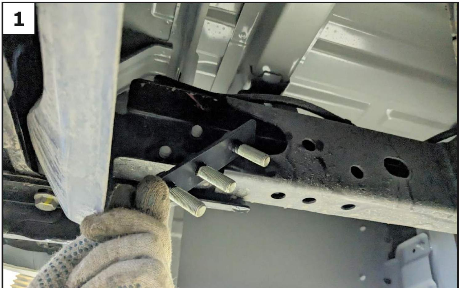
Установить закладную M12x1,25 левую (4) и правую (5) в лонжероны рамы.
