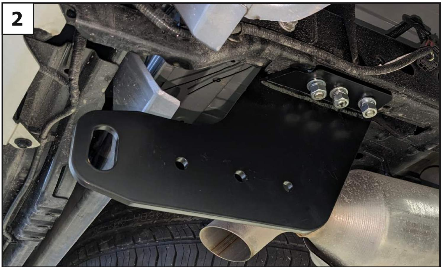
Установить кронштейн правый (3), закрепив его к установленной закладной с помощью гаек M12x1,25 (16), шайб M12 пружинных (20) и шайб 12 (21).
