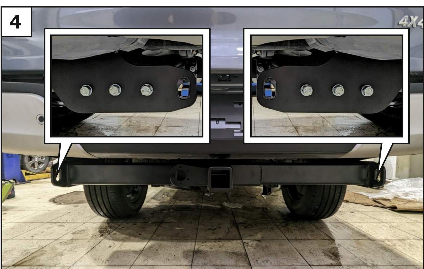
Прогнать резьбовые отверстия балки (1) при помощи метчика M12x1,25. Затем установить балку (1), закрепив ее к кронштейнам с помощью болтов M12x1,25x40 (14), шайб 12 пружинных (20) и шайб 12 (21).
