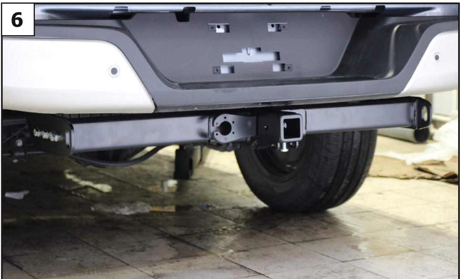
**Установить кронштейн под розетку (11) с помощью болта M8x80 (12), шайбы 8 (18), шайбы 8 увел. (19), шайбы 8 пружинной (17) и гайки M8 (15). Момент затяжки: M8=25 Нм.**
