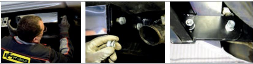
**ШАГ 5.** Установите съемный шар в сборе и закрепите его пальцем гнутым со спиралью пружинным игольчатым. Затяните шар ключом на 38 мм. Установите фиксирующий болт M10x20 снизу, он используется для исключения технологических люфтов съемного шара и только в ненагруженном состоянии! Перед сцепкой болт демонтируйте!
