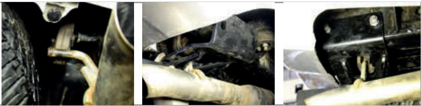
**ШАГ 3.** Установите закладную пластину в нишу правого лонжерона продев шпильку пластины в отверстия лонжерона и кронштейна как показано на фото. Закрепите кронштейн с помощью гайки M12 через гроверную шайбу 12 и шайбу 12. Повторите на левой стороне.
