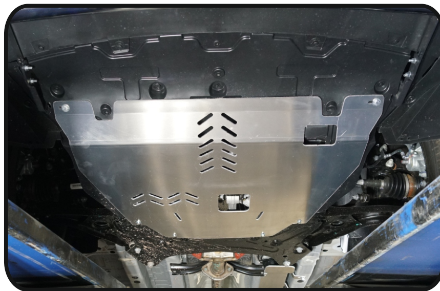
Защита картера и АКПП (алюминий) 4мм арт.ZKTCC00606.
