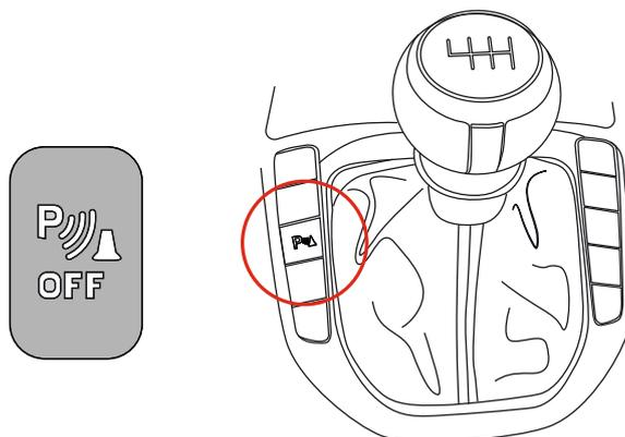
Отключение заднего парктроника можно осуществить, нажав на штатную кнопку в автомобиле, как указано на рисунке.
