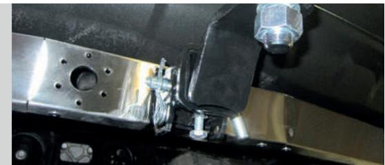
Тип шара «Е»; Тип соединения: шаровый; Диаметр сцепного шара: 50 мм.; Масса комплекта ТСУ LNX991101: 23,7кг
