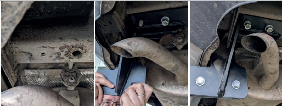
**ШАГ 3.** Закрепите балку ТСУ на правом и левом кронштейнах при помощи болтов M12x1,25x40, шайб 12, шайб 12 гроверных и гаек M12x1,25. **Затяните все соединения, отрегулировав положение ТСУ.**
