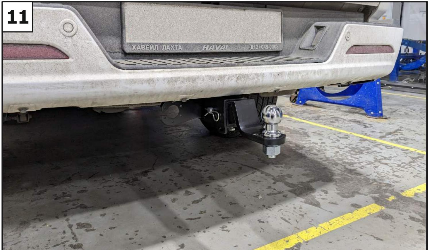
**Установить переходник (9), закрепив с помощью штифта (11) и шплинта (12). Зафиксировать переходник болтом M10x20 (17) - фиксацию использовать без нагрузки. Установить на переходник шар (10), закрепив гайкой M24 (29) с шайбой 24 пружинной (28). Момент затяжки: M24=95 Нм.**
