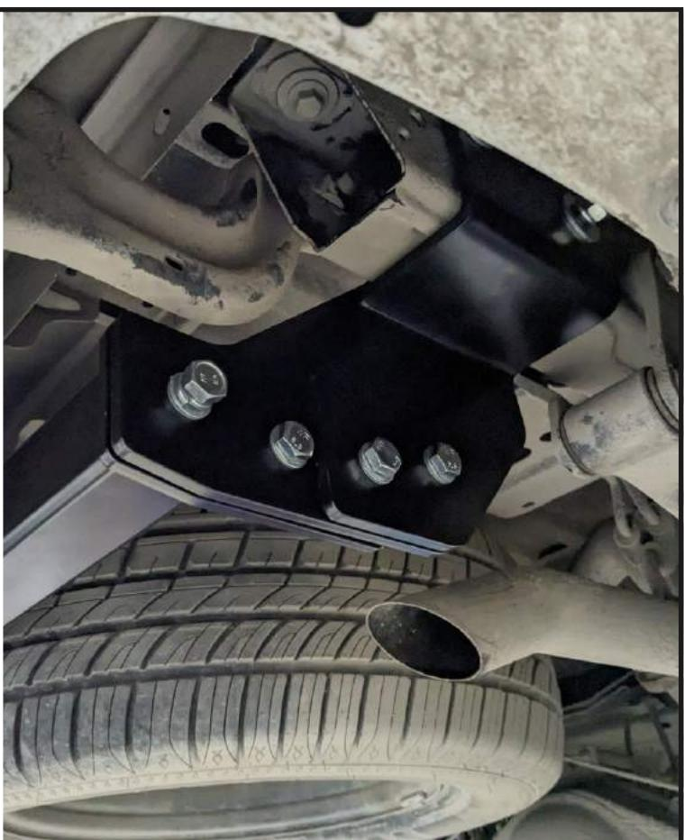
К установленным кронштейнам закрепить балку (1) с помощью болтов M12x1,25x40 (14), шайб 12 (22), шайб 12 пружинных (24) и гаек M12x1,25 (19).
