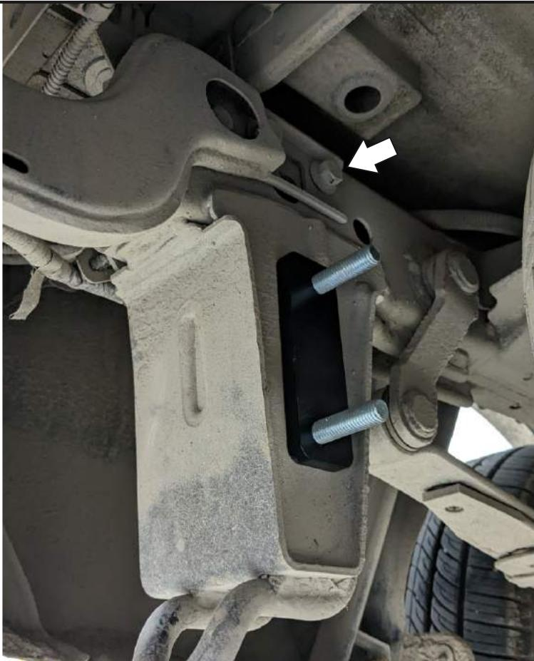
Выкрутить штатный болт кронштейна бампера и после установить болты M12x140 (16) с шайбами 12 увелич. (23) к кронштейну буксировочной петли. С другой стороны установить проставку 2 (8) на болты установленные в кронштейн.
