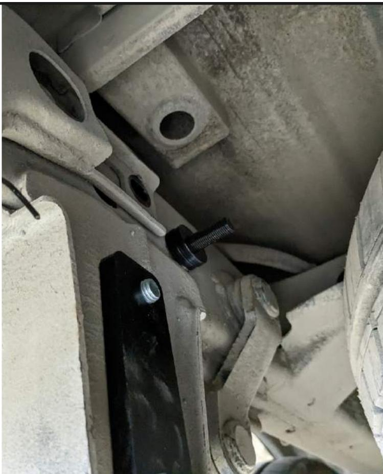
Установить закладную 2 (6) в раму автомобиля . На закладную установить две прокладки 1 (7).
