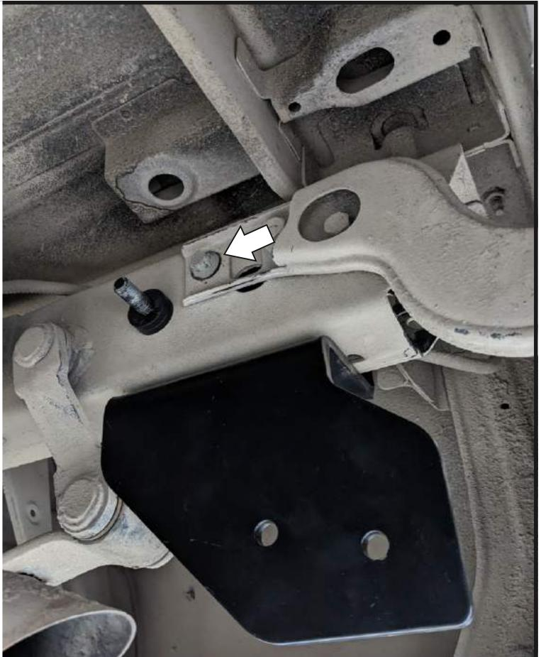
**Выкрутить штатный болт кронштейна бампера и после установить закладную 2 (6) в раму автомобиля и . На закладную установить две проставки 1 (7).**
