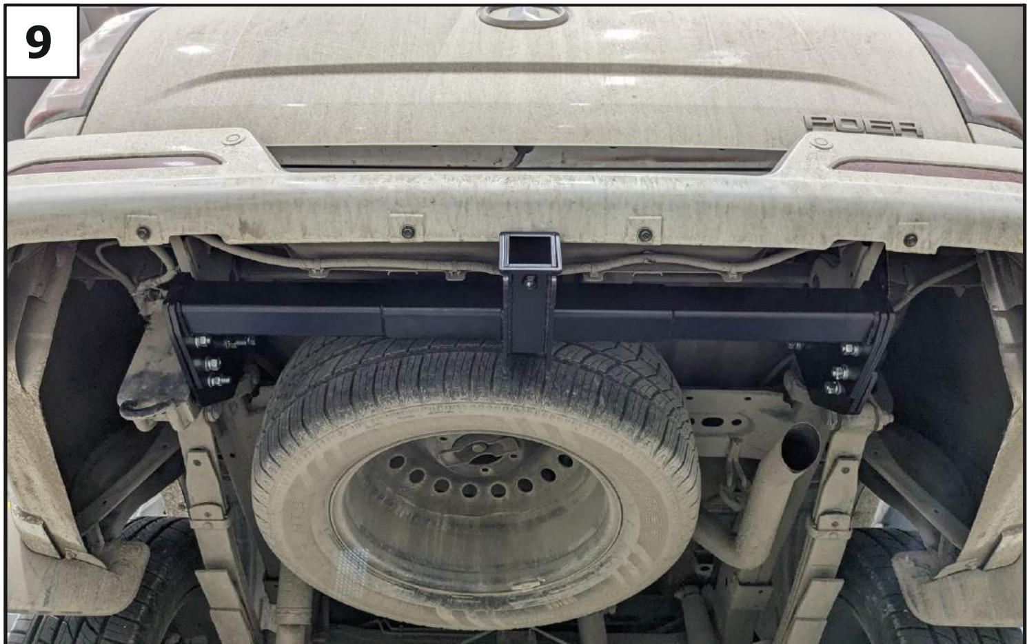
**Затянуть все резьбовые соединения - сначала балку с кронштейнами, после кронштейны к лонжеронам. Момент затяжки: M12= 81Нм.**
