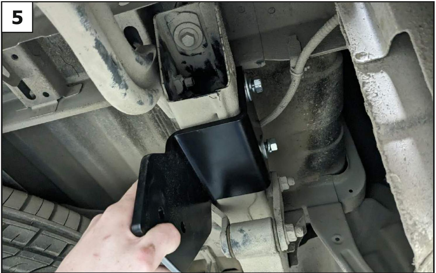
**Установить усиливающий кронштейн (4), закрепив его к закладной в раме с помощью гаек M12x1,25 (19), шайб 12 увел. (23) и шайб 12 пружинных (24) .**
