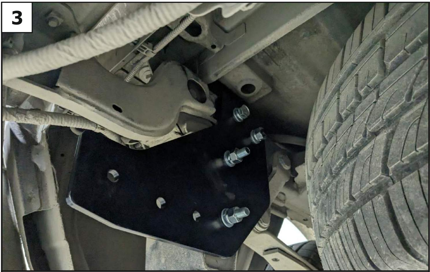
Установить левый кронштейн (2), закрепив его с помощью болта M12x1,25x40 (14), шайб 12 (22), шайб 12 пружинных (24), гаек M12x1,25 (19) и гаек M12 (20).
