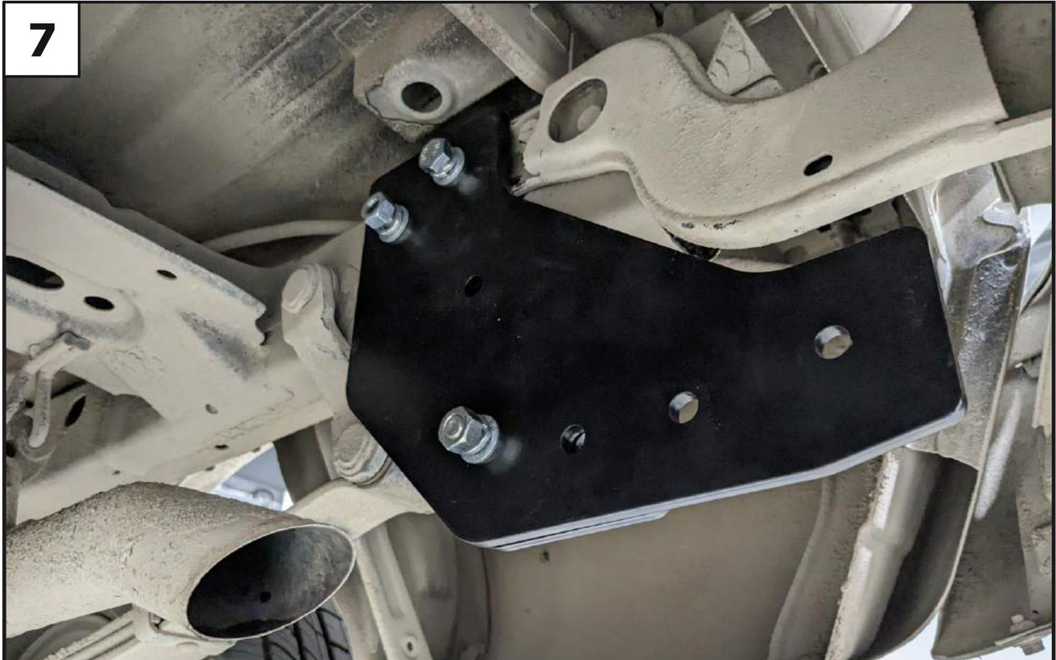
Установить правый кронштейн (3), закрепив его с помощью болта M12x1,25x40 (14), болта M12x1,25x50 (15), шайб 12 (22), шайб 12 пружинных (24) и гаек M12x1,25 (19).
