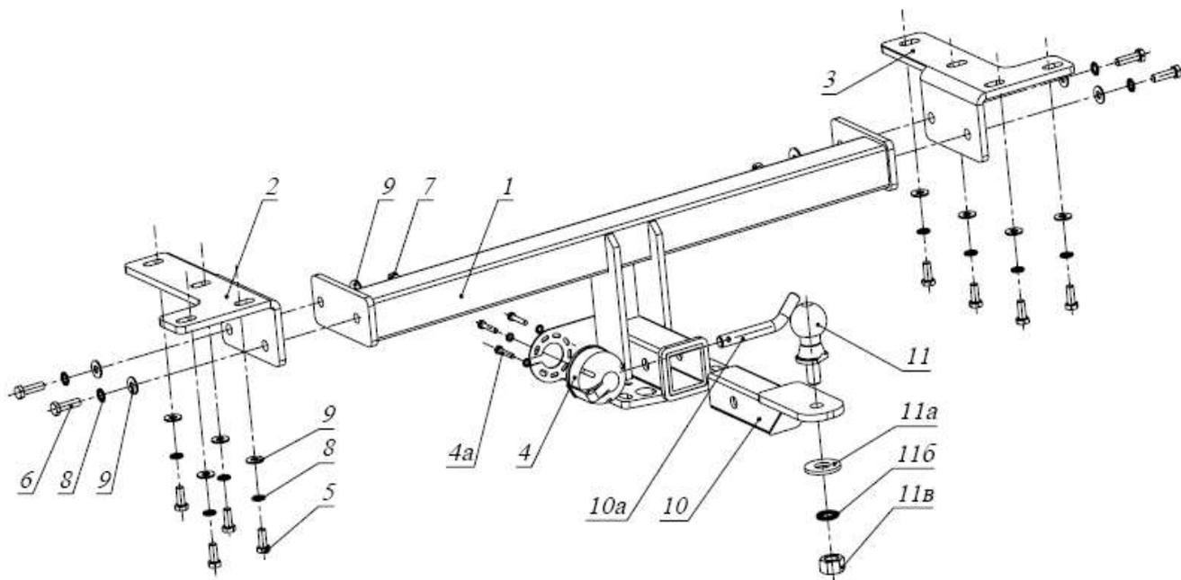
1. Закрепить кронштейны 2,3 к штатным резьбовым отверстиям в раме а/м болтами М12х1,25х25.
