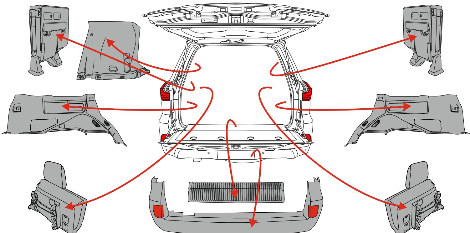
Элементы обшивки, которые рекомендуем демонтировать перед установкой комплекта проводки.
