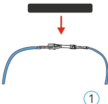
1. Возьмите из комплекта термоусадочную трубку и установите ее на замкнутые контакты «мама», «папа».
