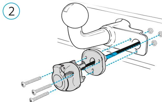
Закрепите розетку и пыльник на монтажной поверхности.
