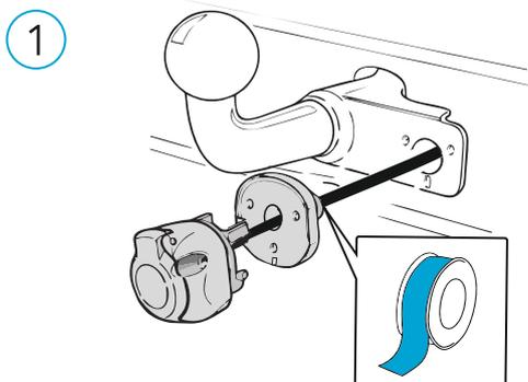
Герметично заизолируйте соединение между пыльником и жгутом провода розетки.
