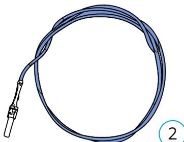
2. Найдите в комплекте синий провод с установленным контактом «папа».
