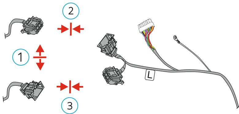
Соедините колодки до щелчка, в порядке, указанном на рисунке, надежно закрепите.
