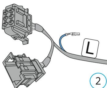
2. Найдите в жгуте «L» синий провод с установленным контактом «мама».
