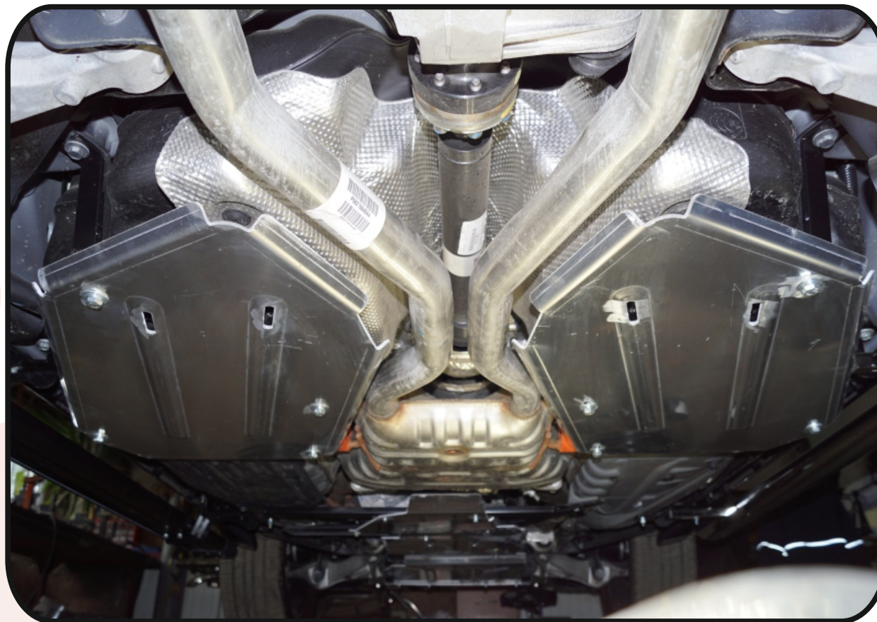
Защита бака (алюминий) 4 мм (компл 2шт) арт. ZKTCC00355.
