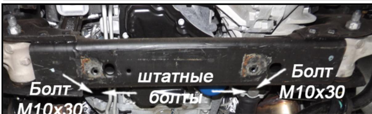
Произвести смазку крепёжных болтов маслом или другой консервационной жидкостью
