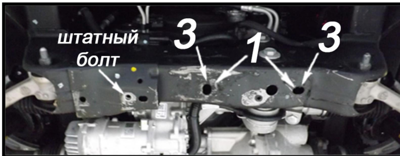
Произвести смазку крепёжных болтов маслом или другой консервационной жидкостью
