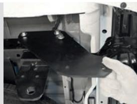
**ШАГ 2.** Установите кронштейн центральный, совместив отверстия кронштейна центрального с отверстиями боковых кронштейнов. Соедините всё с помошью болтов M12x1,25,40 через шайбы на 12 с двух сторон и шайбы пружинные на 12, гайками M12x1,25. Соединения не затягивайте.
