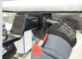
**ШАГ 4.** Зафиксируйте палец гнутий с помощью шплинта игольчатого.
