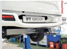
Тип шара «Е»; Тип соединения: шаровый; Диаметр сцепного шара: 50 мм.; Масса комплекта ТСУ GWW991101: 28,5 кг.
