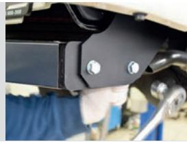
**ШАГ 3.** Отрегулируйте положение центрального кронштейна относительно бампера автомобиля, обеспечив минимальный зазор 10 мм. Затяните все резьбовые соединения начиная с боковых кронштейнов. Установите съемный шар в сборе и закрепите его пальцем гнутым.
