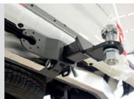
**ШАГ 5.** Зафиксируйте съемный шар болтом M10x20 снизу. Установка завершена.
