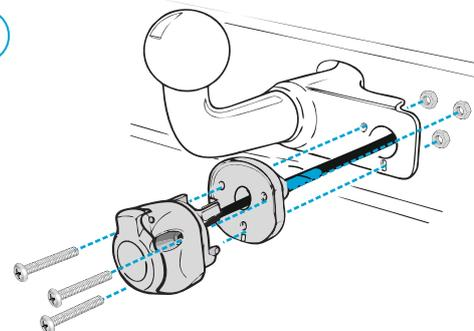
Закрепите розетку и пыльник на монтажной поверхности.
