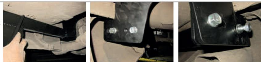
**ШАГ 5.** Установите кронштейн крепления розетки. Установите шар в сборе. Зафиксируйте шар пальцем гнутым (поз. L) и проденьте в него шплинт (поз. K).
