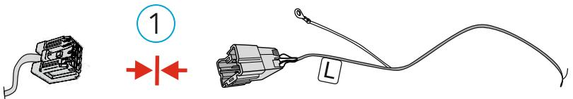
Соедините колодки до щелчка, в порядке, указанном на рисунке, надежно закрепите.
