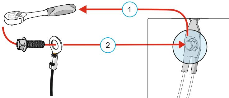
При подключении клеммы «масса» убедитесь, что рекомендуемое место установки не имеет следов коррозии и окисления, а также прочих загрязнений.
