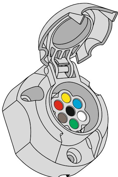
Проведите проверку сигналов, выходящих на розетку тягово-цепного устройства при запущенном, а затем - на заглушенном двигателе автомобиля.
