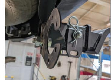
Отрегулируйте положение балки ТСУ относительно бампера автомобиля, обеспечив минимальный зазор 3–5 мм. Затяните соединения всех элементов.
