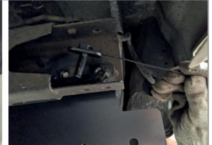
Поместите внутрь лонжерона закладные нижние (шпильками вниз). Поместите в ближайшие отверстия лонжерона болты М12х1.25х30 с шайбами. Установите кронштейн на нижние шпильки и болты. Закрепите шпильки и болты гайками М12х 1,25 через шайбы 12, гроверные шайбы 12 и прокладки (см. схему). Соединения не затягивать!
