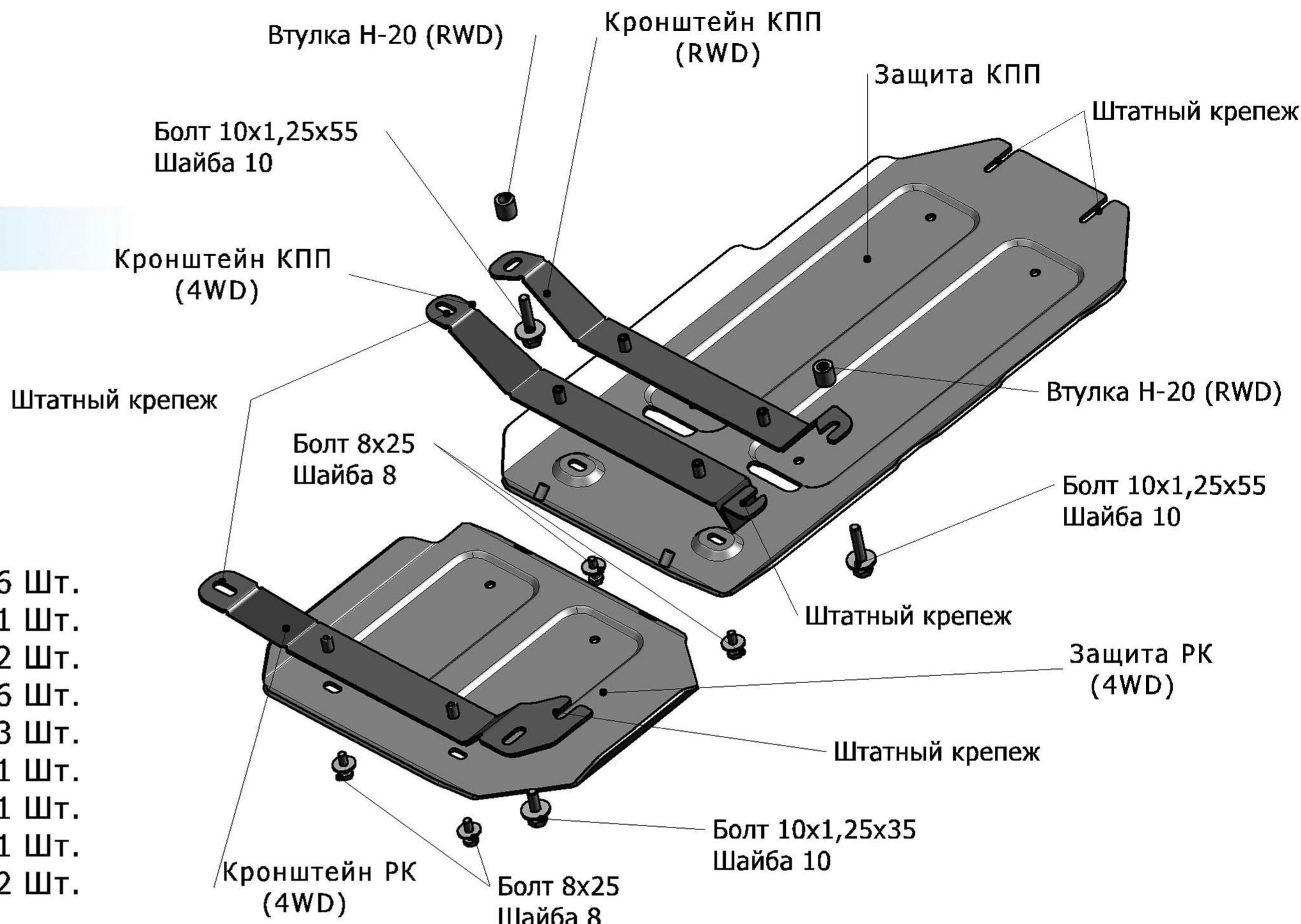
6. Установить кронштейн РК в штатное место штатным крепежом и дополнительным болтом M10x1,25x35.
