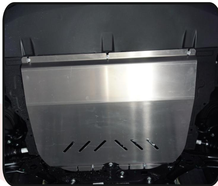
**Защита картера и КПП (алюминий) 4 мм
