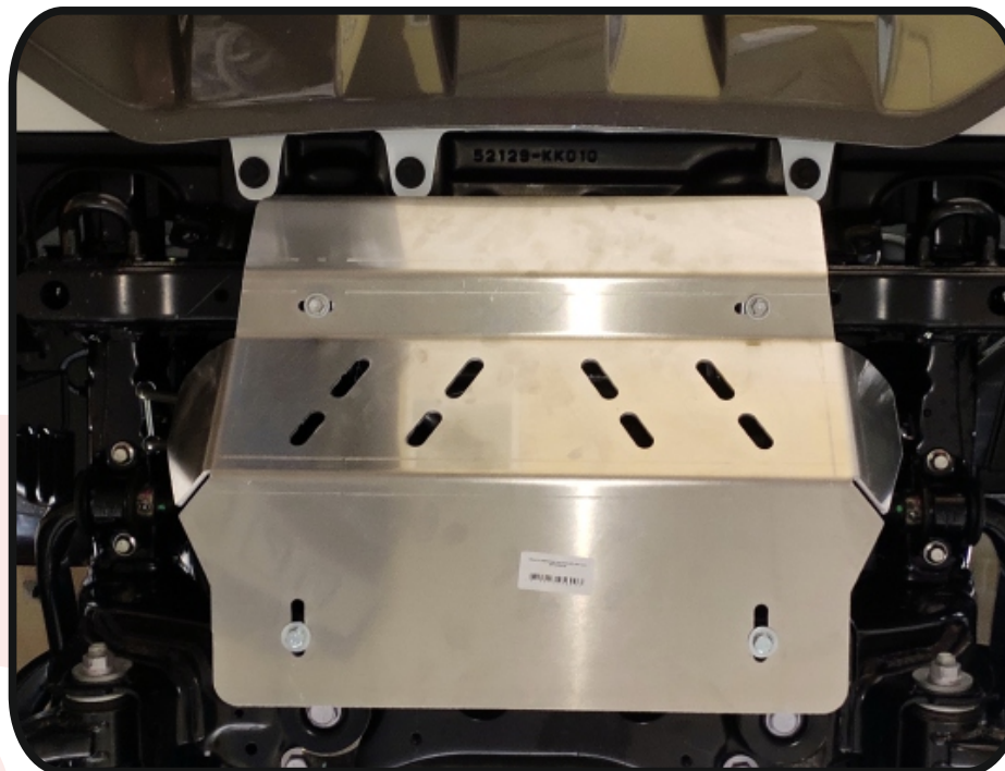
Защита радиатора (алюминий) 4 мм арт. ZKTCC00156
