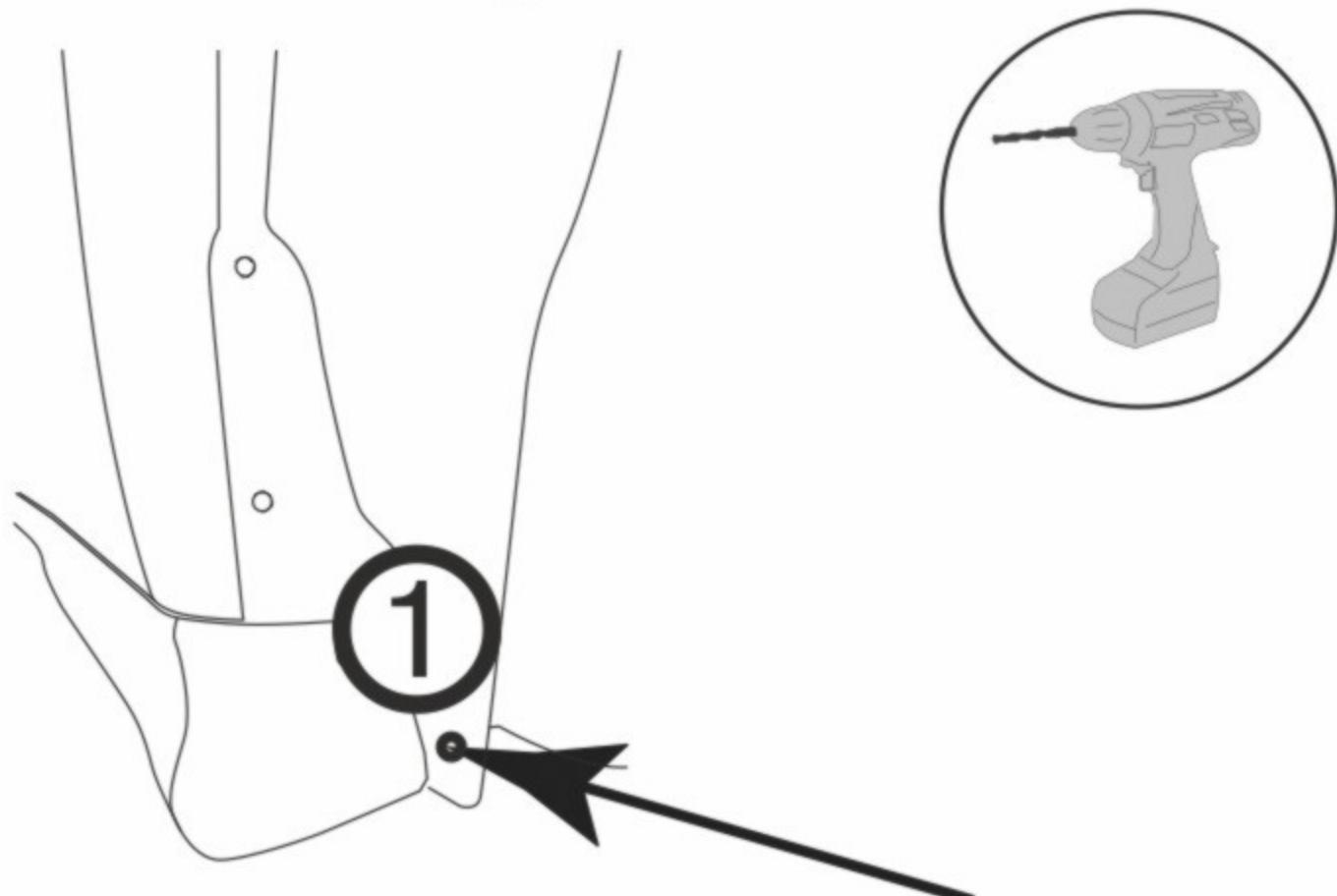
Используя сверло Ø 8 мм, просверлить
