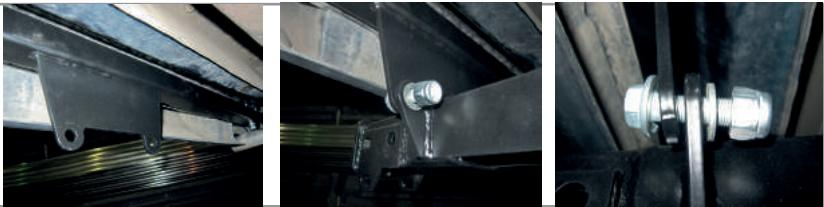
**ШАГ 3.** Совместите отверстия в кронштейне с отверстиями в лонжероне и проденьте сквозь отверстия лонжерона болты M10x90. Закрепите всё с помощью самоконтрящихся гаек M10 через шайбы 10 увеличенные.
