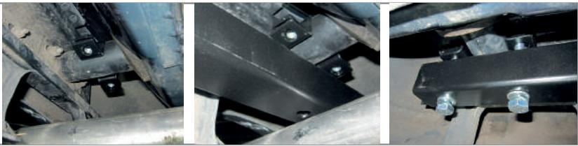
**ШАГ 2.** Для установки центрального кронштейна совместите отверстия кронштейна с отверстиями в ушках балки ТСУ и соедините болтами M12x1,25x45 через шайбы 12 и самоконтрящиеся гайки M12x1,25.
