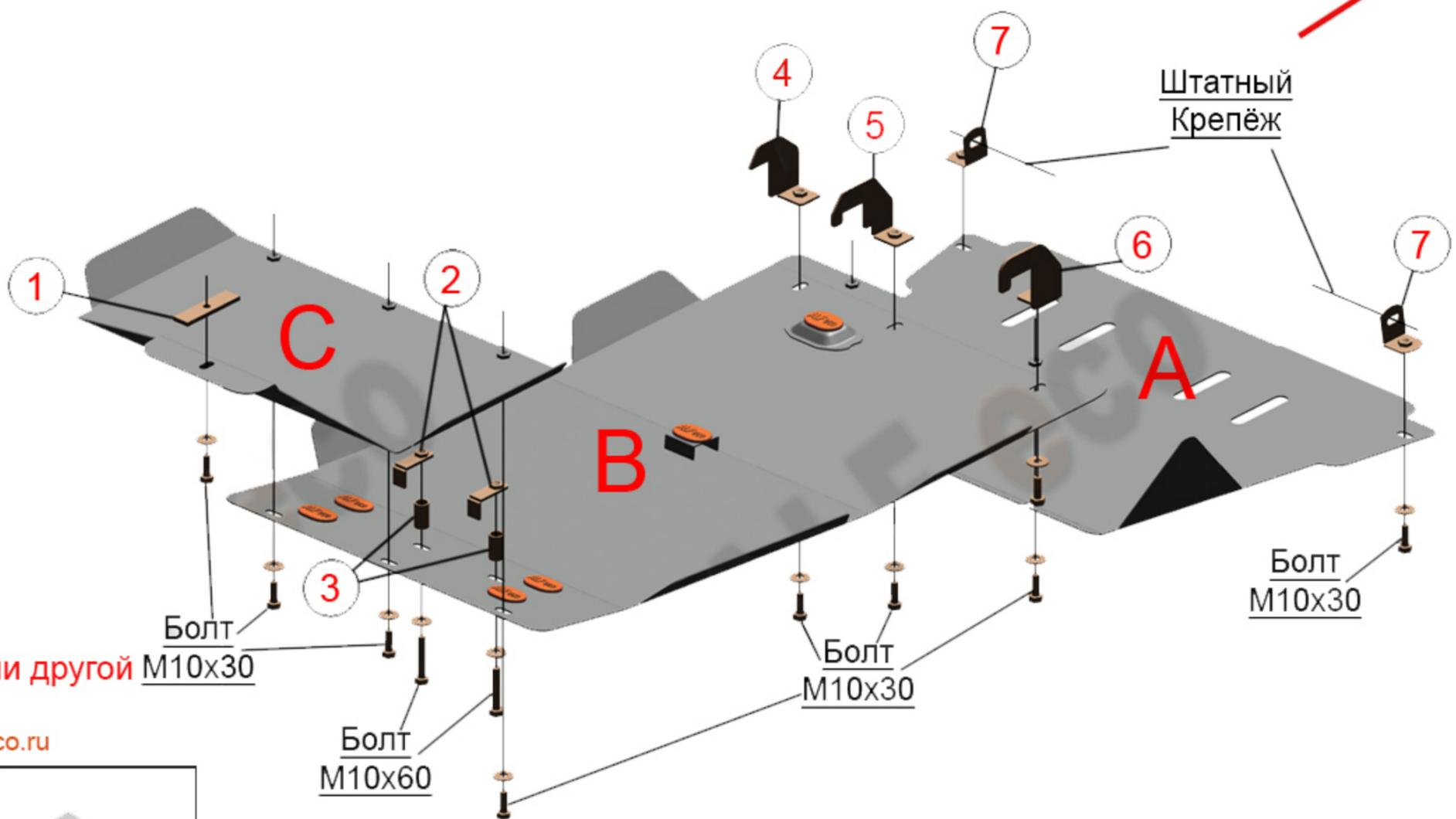
Произвести смазку крепёжных болтов маслом или другой консервационной жидкостью
