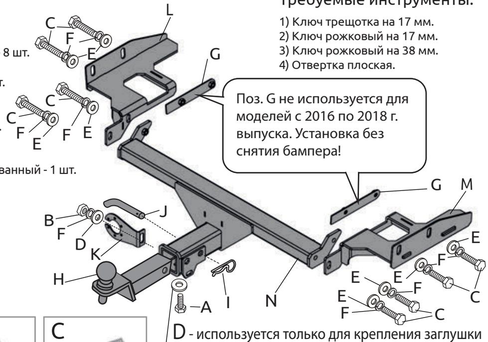
Поз. G не используется для моделей с 2016 по 2018 г. выпуска. Установка без снятия бампера!
