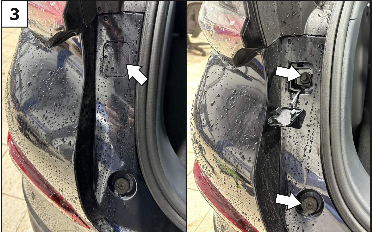
**Снять заглушку и выкрутить болт и винт крепления бампера. С другой стороны сделайте аналогично и демонтировать бампер.**
