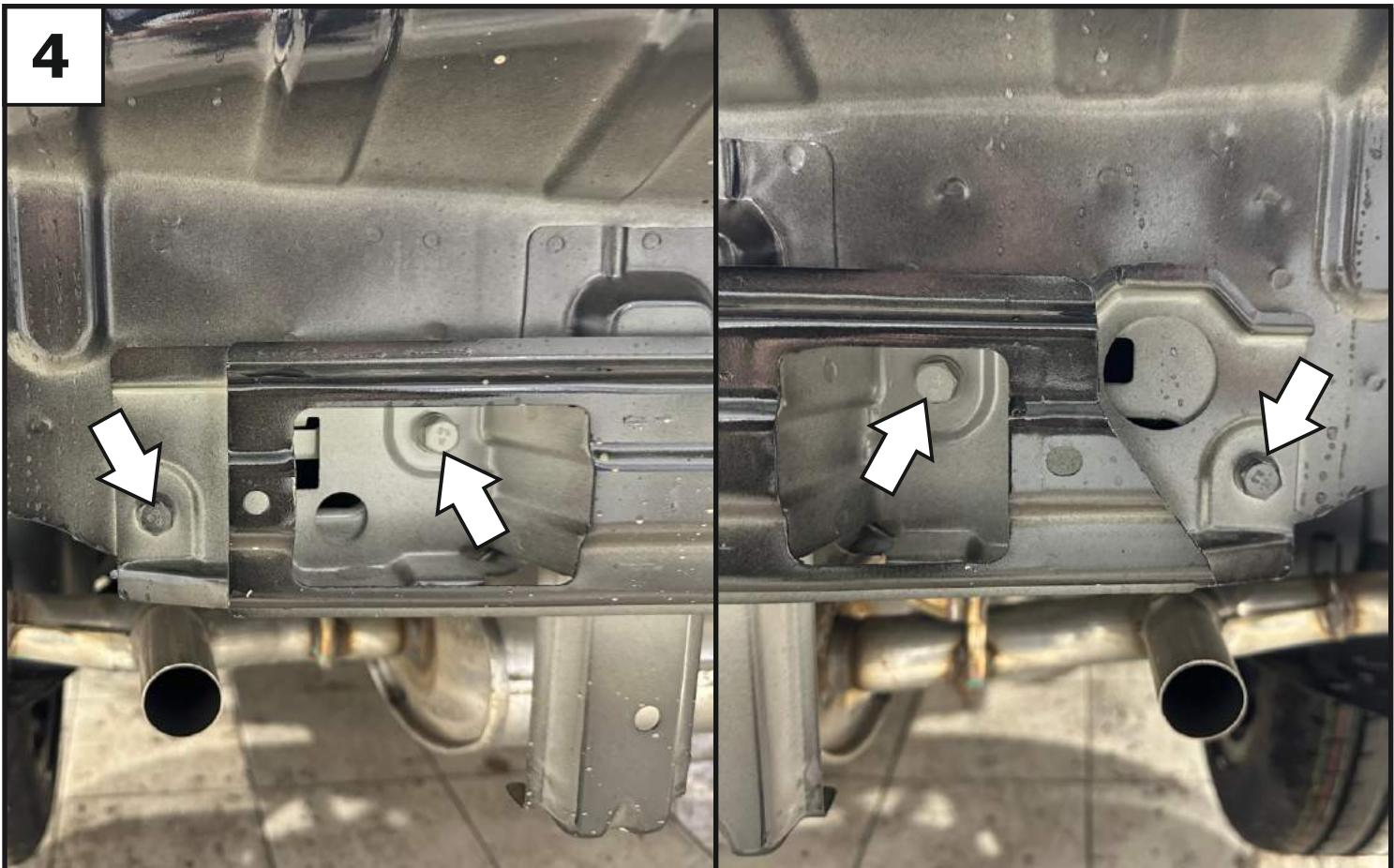
**Выкрутить штатные болты крепления усилителя бампера и демонтировать усилитель.**
