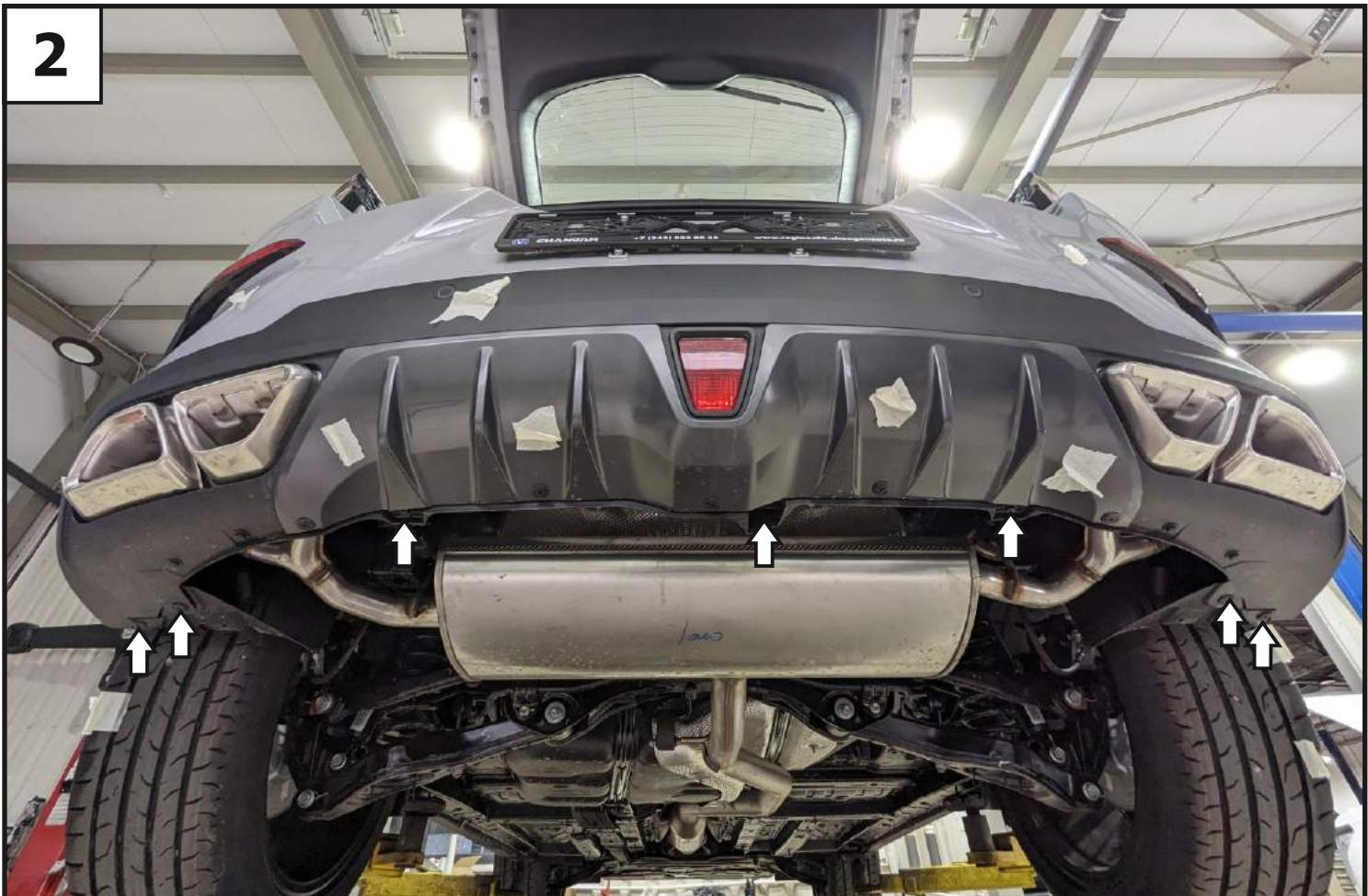
Выкрутить винты и болты крепления бампера.
