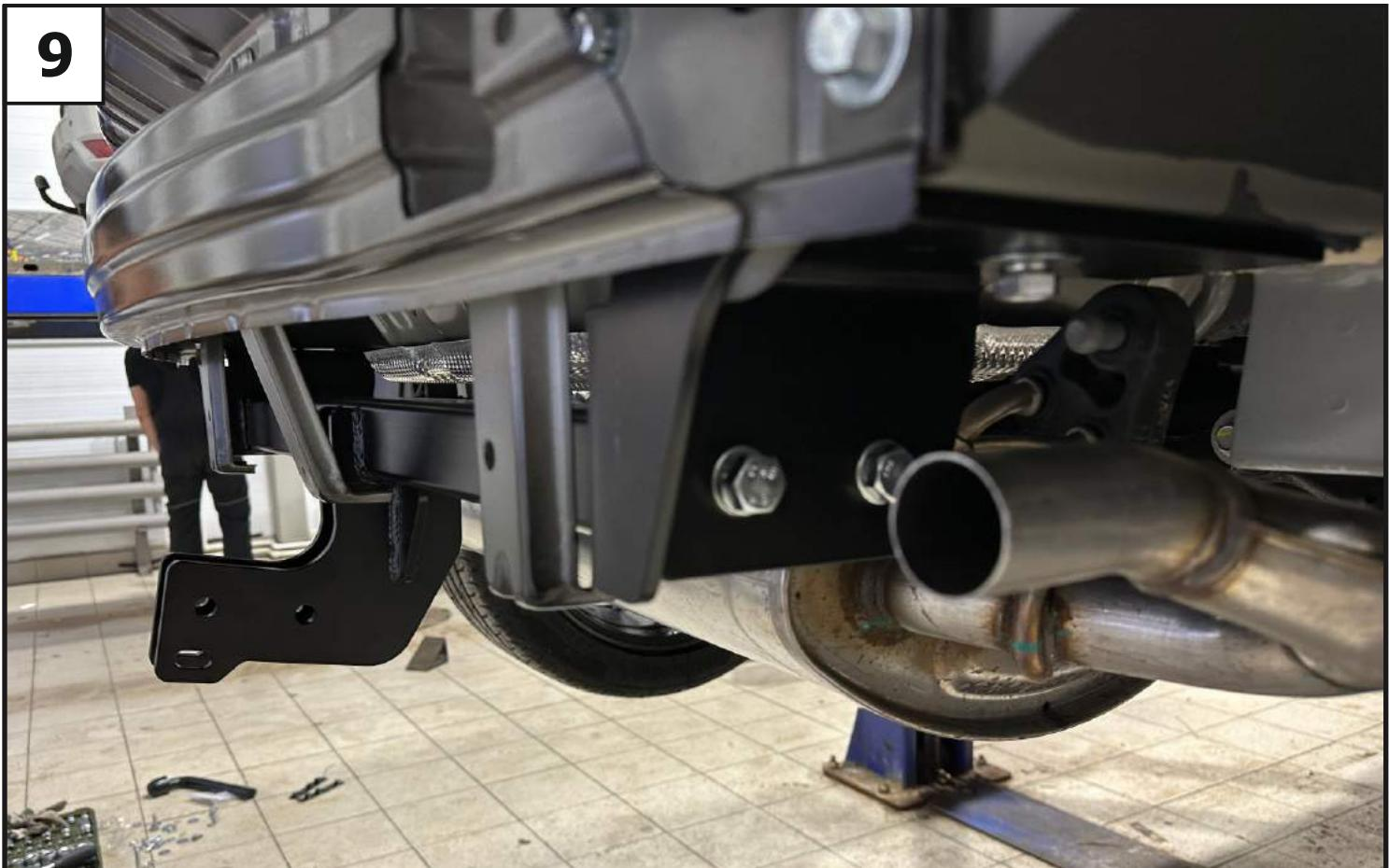
Прогнать резьбовые отверстия балки (1) при помощи метчика M12x1,25. Затем установить балку, закрепив к кронштейнам с помощью болтом M12x1,25x45 (11), шайб 12 пружинных (18), шайб 12 (19) и гаек m12x1,25 (13).
