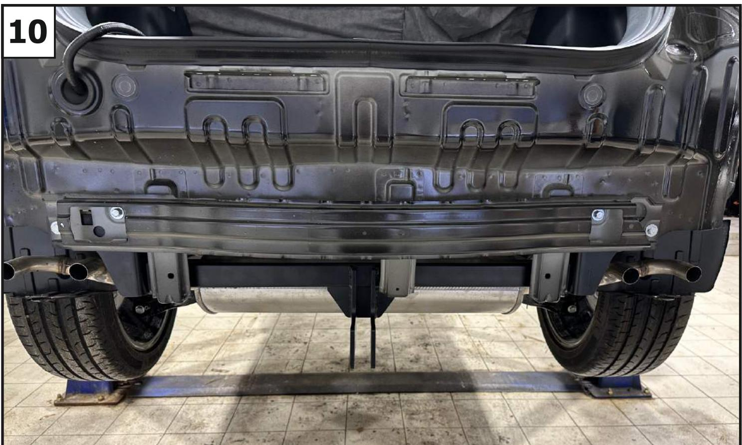
Затянуть все резьбовые соединения: сначала балку к кронштейнам, затем потом кронштейны к лонжеронам, потом кронштейны к задней панели. Моменты затяжки M8=25 Нм; M10=47 Нм; M12=81 Нм. Установить бампер в обратном порядке.
