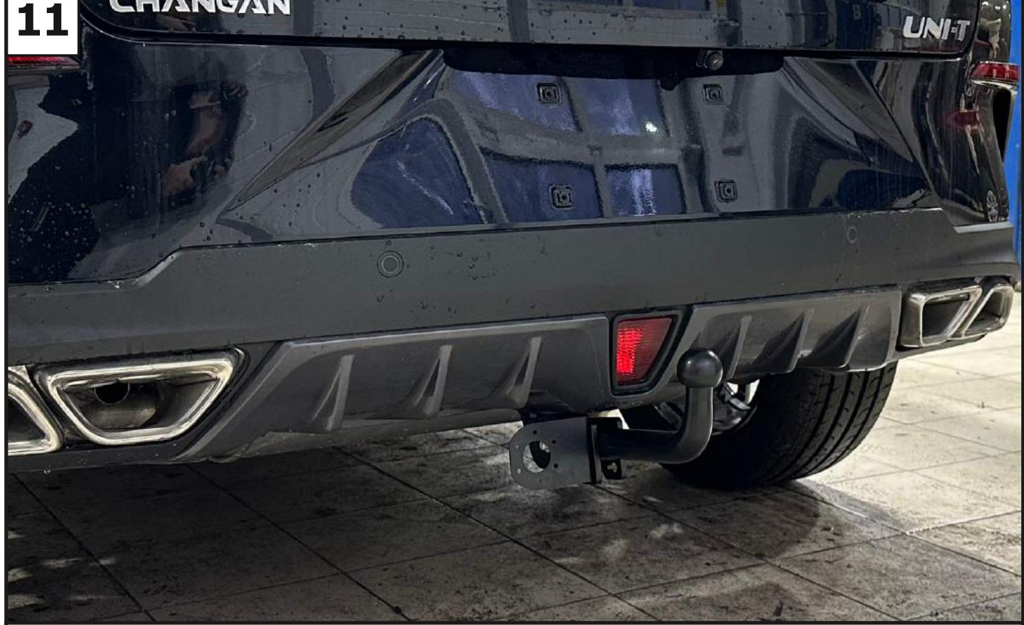
Установить кронштейн под розетку (7) и крюк (8) с помощью болтов M12x1,25x70 (12), шайб 12 пружинных (18), шайб 12 (19) и гаек M12x1,25 (13).
