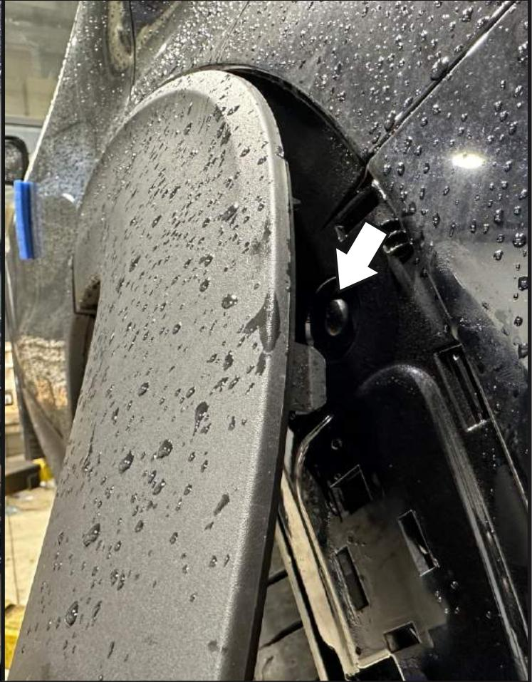
Отщелкнуть боковую накладку и выкрутить винт крепления бампера. С другой стороны аналогично.
