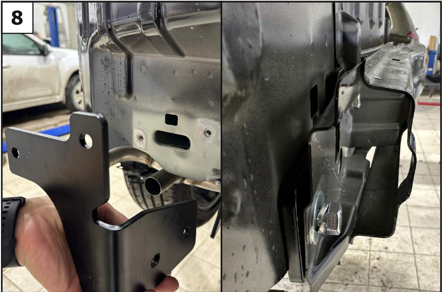
**Установить левый и правый кронштейны (4 и 5) с усилителем бампера к задней панели с помощью болтов M8x30 (9), шайб 8 пружинных (14) и шайб 8 увеличенных (15).**
