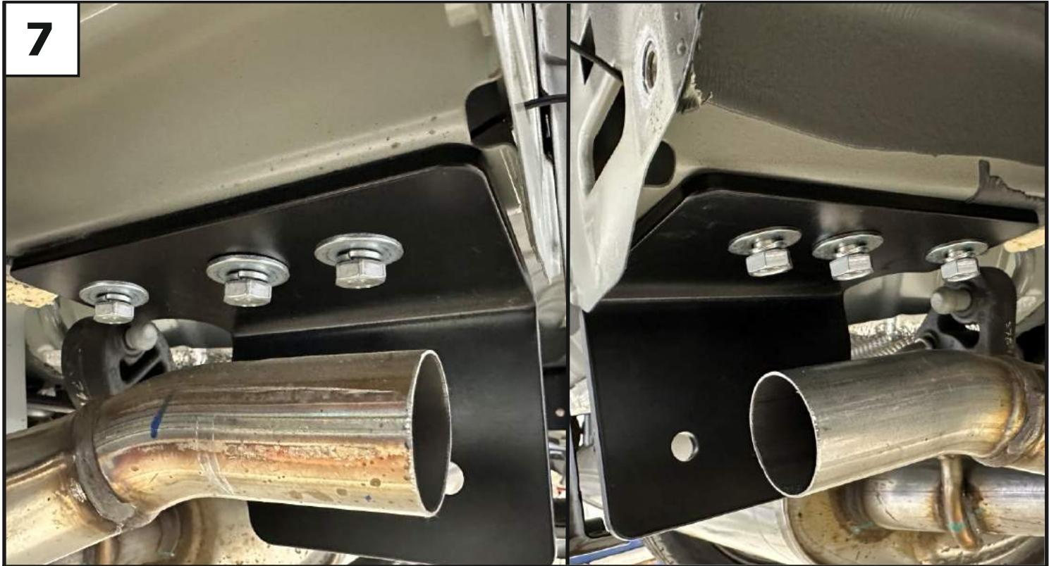
**Установить кронштейны (2 и 3), закрепив их к установленным закладным с помощью болтов M10x1,25x35 (10), шайб 10 пружинных (16) и шайб 10 увеличенных (17).**
