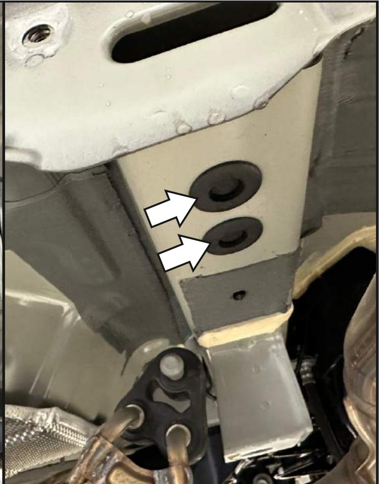
Снять заглушки на лонжеронах
