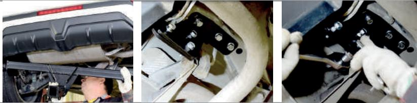
**ШАГ 5.** Закрепите кронштейн крепления электрической розетки гайкой M10 с шайбой. Установите съемный шар в сборе и закрепите его пальцем гнутым со сплинтом. Затяните шар ключом на 38 мм.
