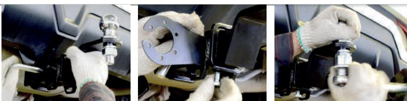
**ШАГ 6.** Установите фиксирующий болт M10x20 снизу, он используется для исключения технологических люфтов съемного шара и только в ненагруженном состоянии! Перед сцепкой болт демонтировать!
