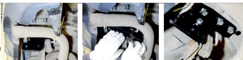
**ШАГ 4.** Для установки балки ТСУ совместите отверстия в балке ТСУ с резьбовыми отверстиями боковых кронштейнов и соедините помощью болтов M10x30x1,25, через шайбы 10. Затяните все резьбовые соединения.
