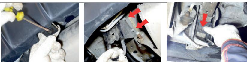
**ШАГ 2.** Установите кронштейн (поз. Q) и прикрутите его с помощью болтов M12x1,25x110 продетых сквозь лонжерон, гайками M12x1,25 через шайбы 12 и шайбы 12 гроверные.
