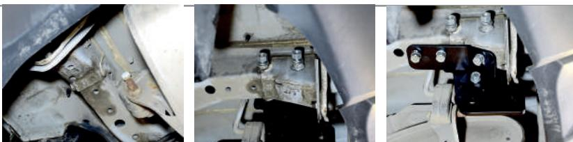
**ШАГ 3.** Установите пластилину гнутую (поз. Р) и прикрутите её к лонжерону с помощью болтов M10x1,25x40 через шайбы 10 и к кронштейну с помощью болта M10x30x1,25 через шайбы 10 с двух сторон, шайбы 10 гроверные и гайки M10x1,25. Повторите шаги 2-3 для другой стороны.
