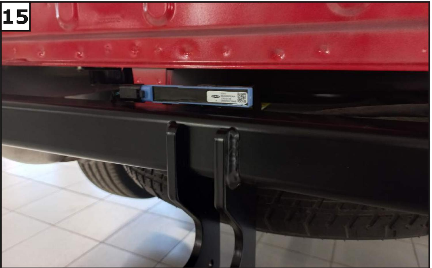
Установить кронштейн антенны (4) и закрепить с помощью болтов М6х20 (9), гаек М6 (13), шайб 6 пружинных (16) и шайб 6 (17).
