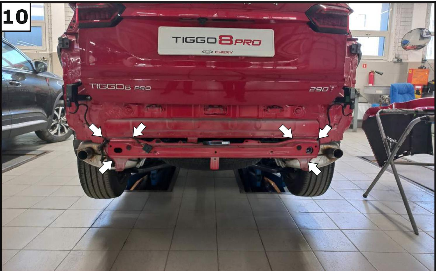
Отсоединить точки крепления проводки и антенну бесключевого доступа от заднего усилителя и открутить гайки крепления усилителя.
