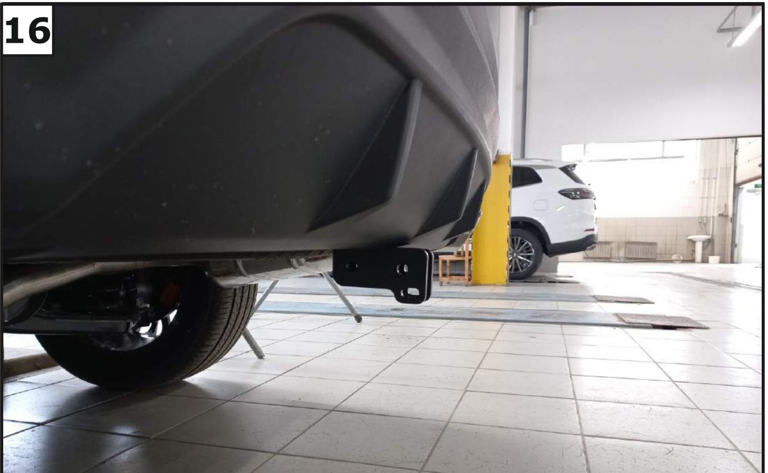
Затянуть все резьбовые соединения, сначала затянуть балку с кронштейнами, затем к задней панели и лонжеронам. Моменты затяжки: М6=10 Нм, М8=25 Нм, М10=47 Нм. После установить бампер в обратной последовательности.
