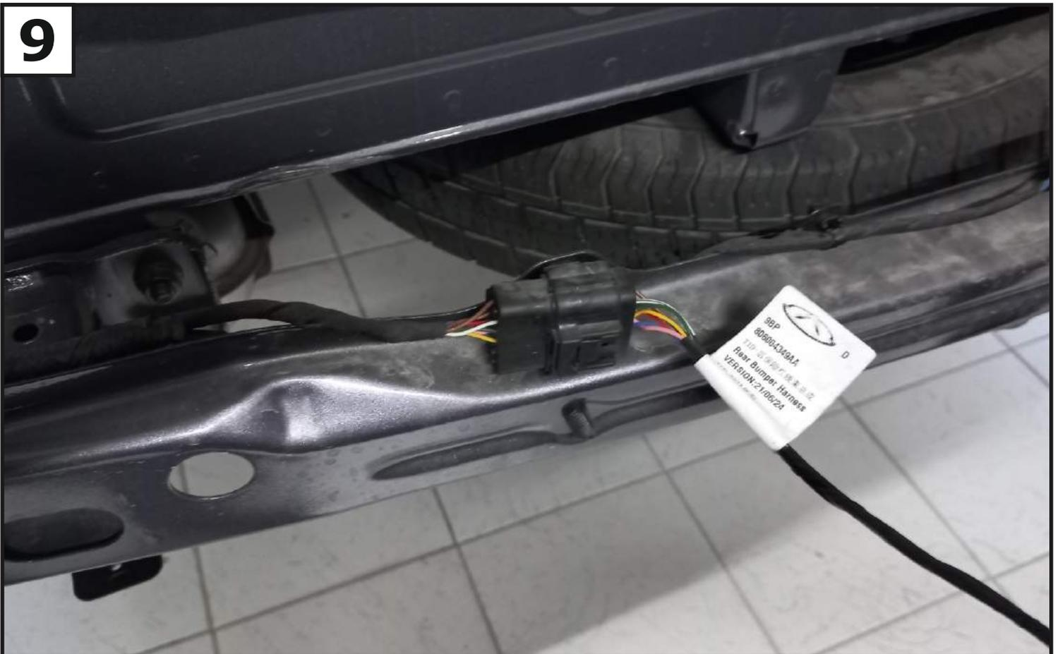
Для снятия заднего бампера необходимо отсоединить разъем проводки заднего бампера.
