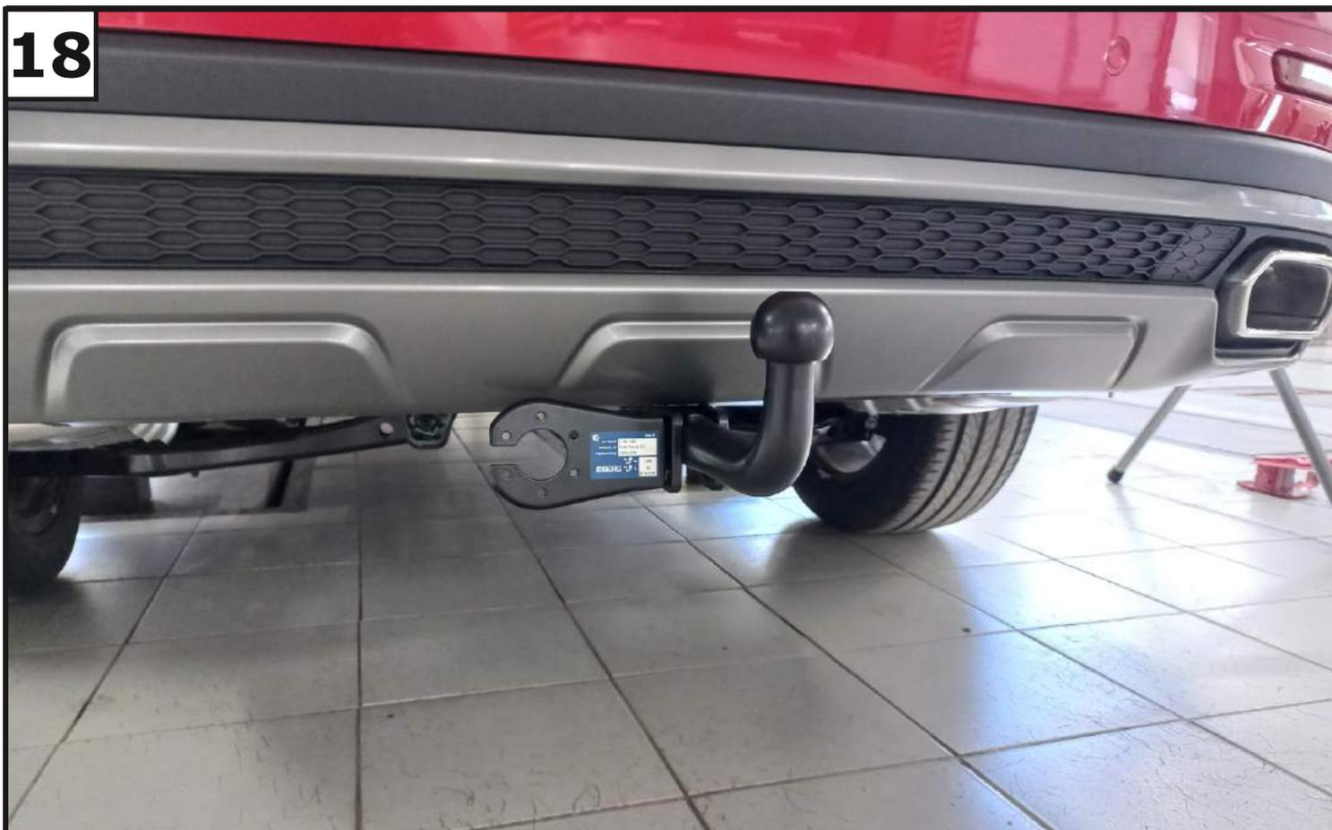
Установить подрозетник (7) и крюк (8) с помощью болтов М12х1.25х70 (12), шайб 12 пружинных (24), шайб 12 (25) и гаек М12х1.25 (15).
