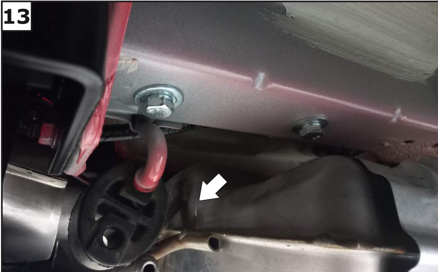
Установленные кронштейны (2 и 3) дополнительно закрепить с помощью болтов М8х30 (10), шайб 8 пружинных (19), шайб 8 увел. (20) и болтов М10х1,25х30 (11), шайб 10 пружинных (21) и шайб 10 увел. (23). Для удобства рекомендуется снять подвес глушителя.
