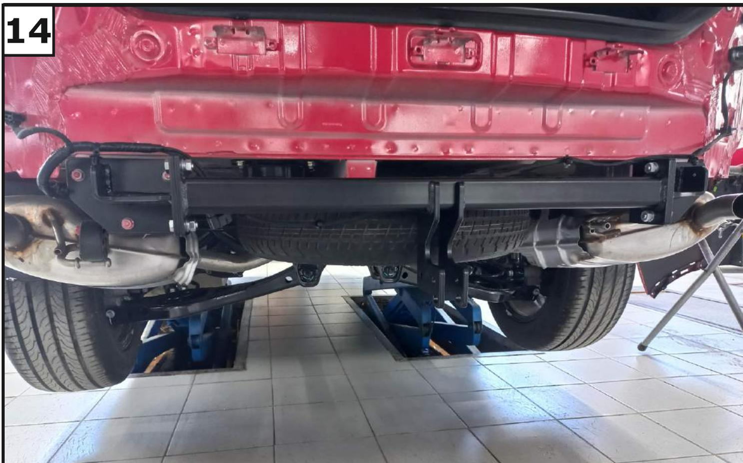
К кронштейнам закрепить балку (1) с помощью болтов М10х1,25х30 (11), гаек М10х1,25 (14), шайб 10 пружинных (21) и шайб 10 (22).
