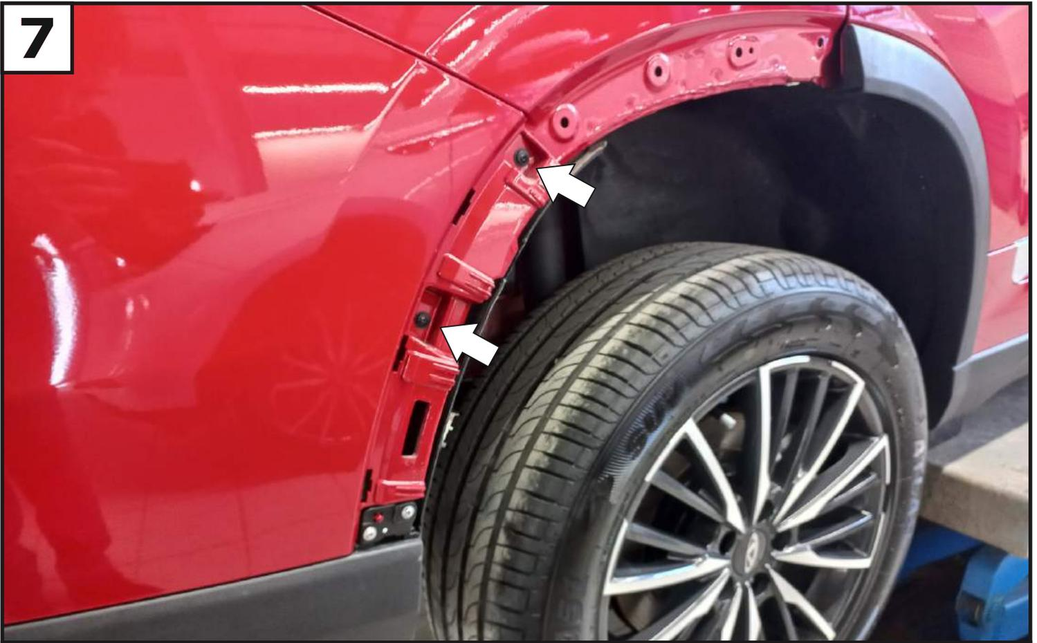
После демонтажа боковой накладке выкрутить винты крепления бампера. С другой стороны аналогично.
