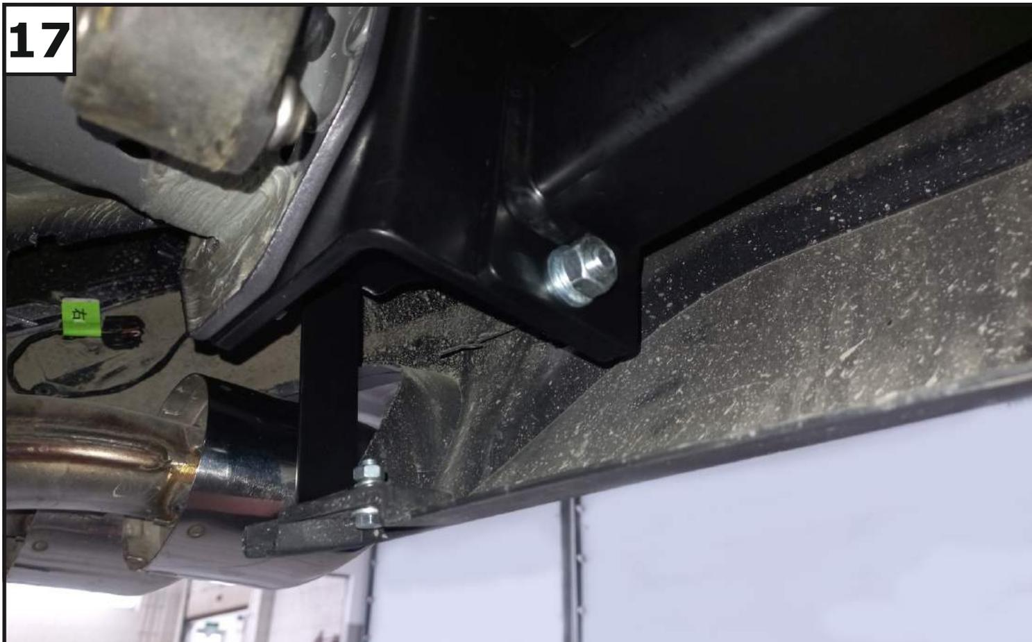
Установить крепления бампера (5 и 6) на кронштейны (2 и 3) с помощью болтов М6х20 (9), шайб 6 пружинных (16), шайб 6 (17) и гаек М6 (9). Бампер закрепить с помощью болтов М6х20 (9), шайб 6 пружинных (16), шайб 6 увел. (18) и гаек М6 (9).
