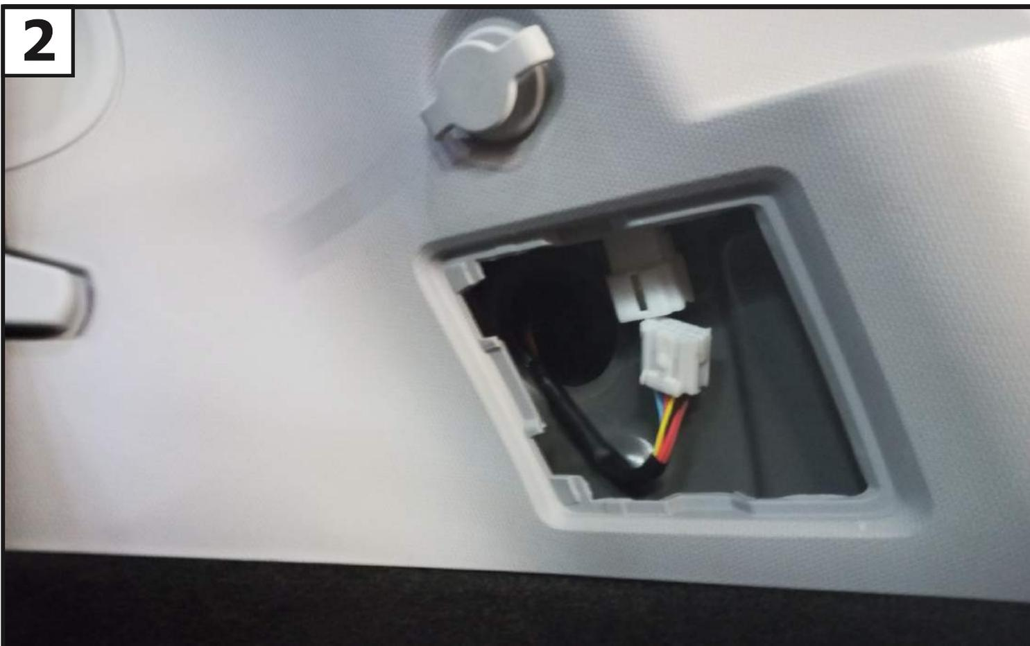
**В багажнике снять заглушки обшивки и отсоединить фишку заднего фонаря. Далее демонтировать фонарь. С другой стороны аналогично.**
