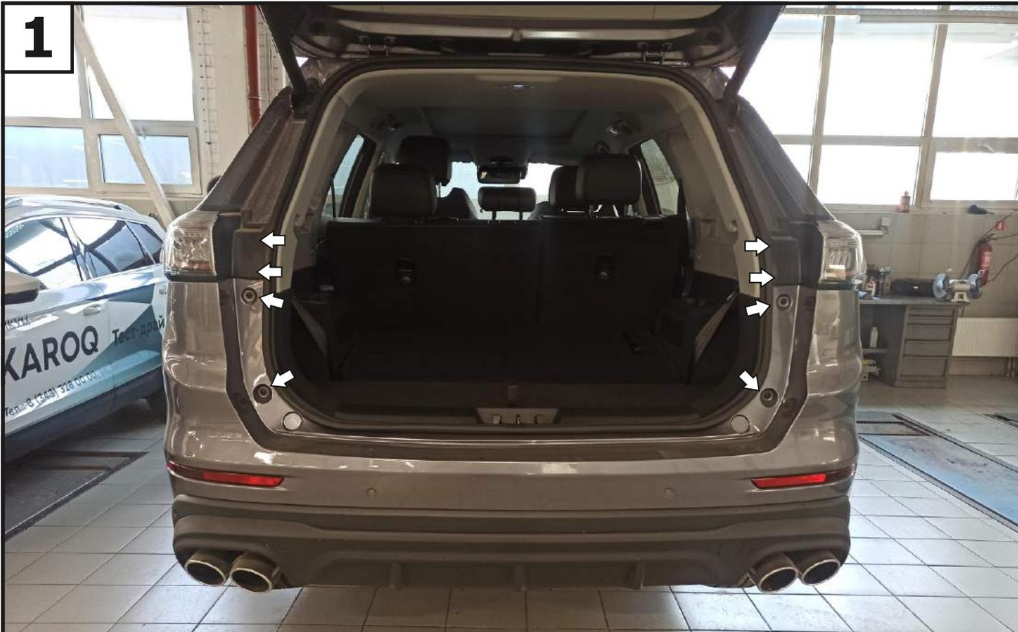
**Открыть заглушки фонарей и выкрутить винты заднего левого и правого фонаря, после выкрутить винты крепления бампера.**
