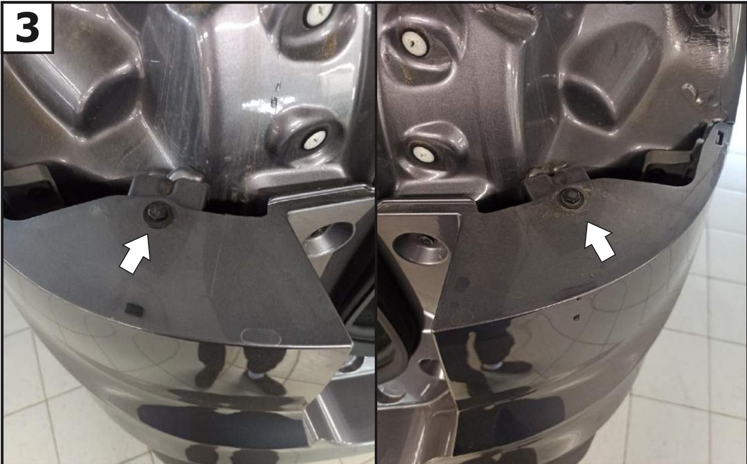
После снятия задних фонарей открутить болты крепления бампера с левой и правой стороны автомобиля.
