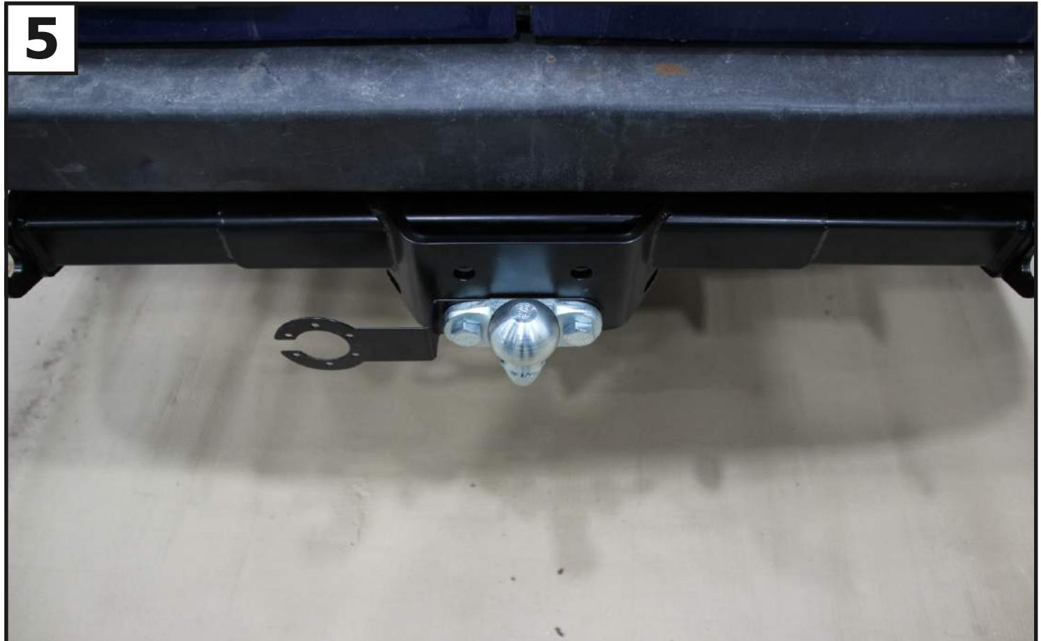
Установить крюк (5) и кронштейн под розетку (4), используя болты M16x50 (6), шайбы 16 (7), гайки M16 (8).
