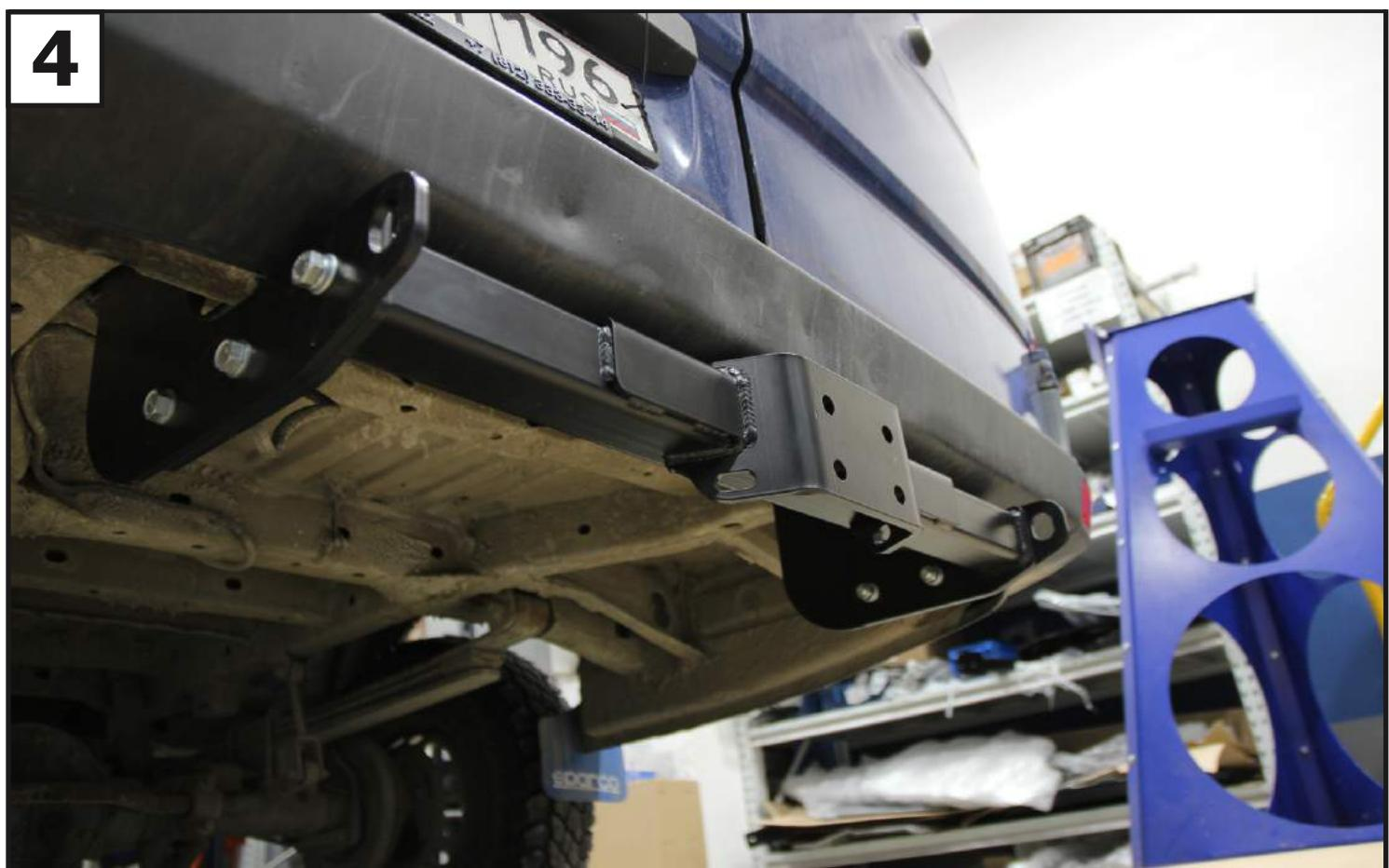
На установленные кронштейны закрепить балку (1), при помощи болтов М12x1.25x40 (13), шайб 12 (10), шайб 12 пруж (11), гаек М12x1.25 (14).
