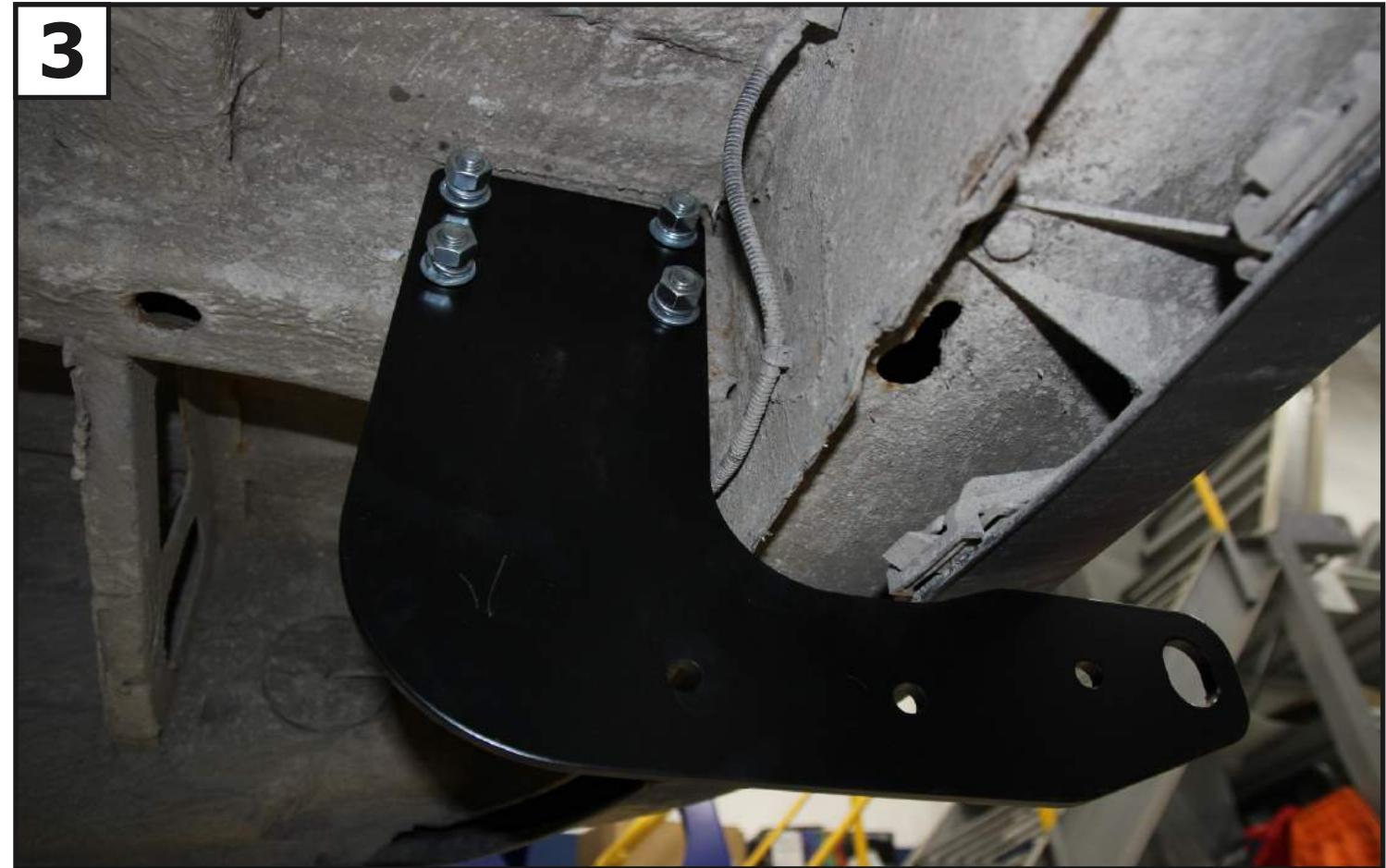
Установить кронштейн (2) с внутренней стороны лонжерона на установленные болты М12x110 (9), закрепив с помощью гаек М12 (12), шайб 12 (10), шайб 12 пруж (11). С другой стороны аналогично.
