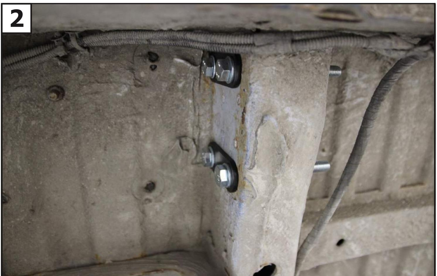
**С внешней стороны лонжерона установить пластины (3) с помощью болтов М12х110 (9), шайб 12 (10) в штатные отверстия. С другой стороны аналогично.**
