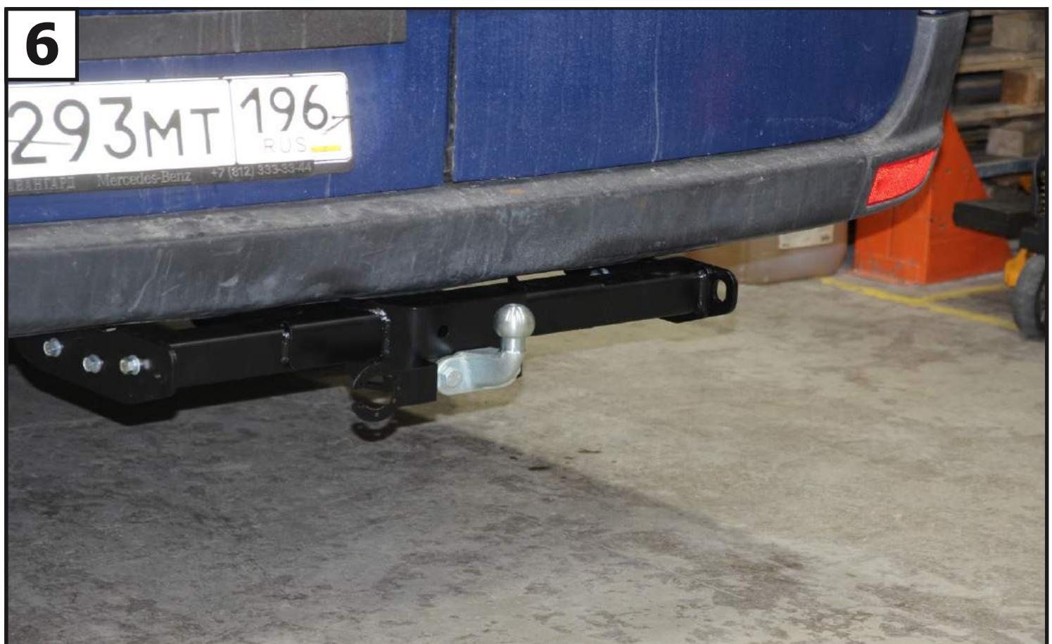
Затянуть все резьбовые соединения. Моменты затяжки: M12=81 Нм, M16=200 Нм.
