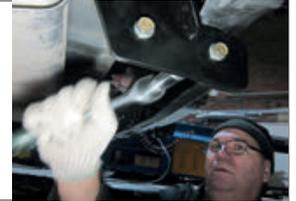
**ШАГ 5.** Установите съёмный шар в сборе и закрепите его пальцем гнутым со шплинтом. Перед установкой фартуков просверлите в них отверстия под шпильки.
