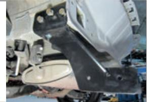
**ШАГ 4.** Установите бампер. Установите балку ТСУ, совместив отверстия балки ТСУ и боковых кронштейнов. Соедините их с помощью болтов М12х1,25х40 гайками М12х1,25 через шайбы 12 с двух сторон.
