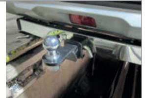
**ШАГ 6.** Затяните шар ключом на 38 мм. Установите фиксирующий болт М10х20 снизу, он используется для исключения технологических люфтов съёмного шара и только в ненагруженном состоянии! Перед сцепкой болт демонтировать!
