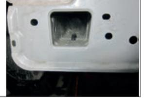
**ШАГ 3.** Установите кронштейны, совместив отверстия в кронштейнах и в лонжеронах, и с закладными шпильками М8. Закрепите кронштейны с помощью болтов М12х1,25х40 через шайбы и гроверы. И с помощью гаек М8 через шайбы 8.
