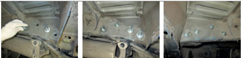
**ШАГ 3.** Установите балку ТСУ, совместив отверстия в закладных и в балке ТСУ. Соедините их с помощью болтов M10x1,25x40 через шайбы 10 гроверные и шайбы 10 увеличенные, гайками M10x1,25. Затяните все соединения.
