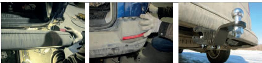
**ШАГ 6.** Вкрутите стопорный винт M10x20 снизу, он используется для исключения технологических люфтов съемного шара и только в ненагруженном состоянии! Перед сцепкой болт демонтировать! Установка завершена.
