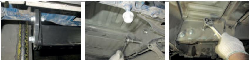
**ШАГ 4.** С помощью хомутов из комплекта поставки прикрепите проводку парктроников к кузову автомобиля и к отверстиям в закладных пластинах, как показано на фото. Обрежьте усики хомутов с помощью ножа или кусачек.
