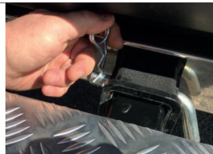
**ШАГ 3.** Зафиксируйте кронштейн фаркопа болтом М10х20 снизу.
