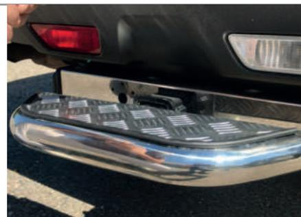
**ШАГ 2.** Установите палец для фаркопа и зафиксируйте его шплинтом пружинным.
